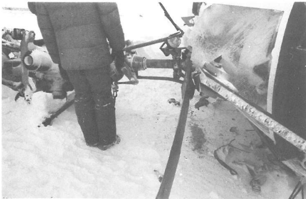
Bild 7. Rotormasten pekar mot helikopterns ovansida. Rotorhuvudet ligger under höger frontruta som krossats av rotorhuvudet.
