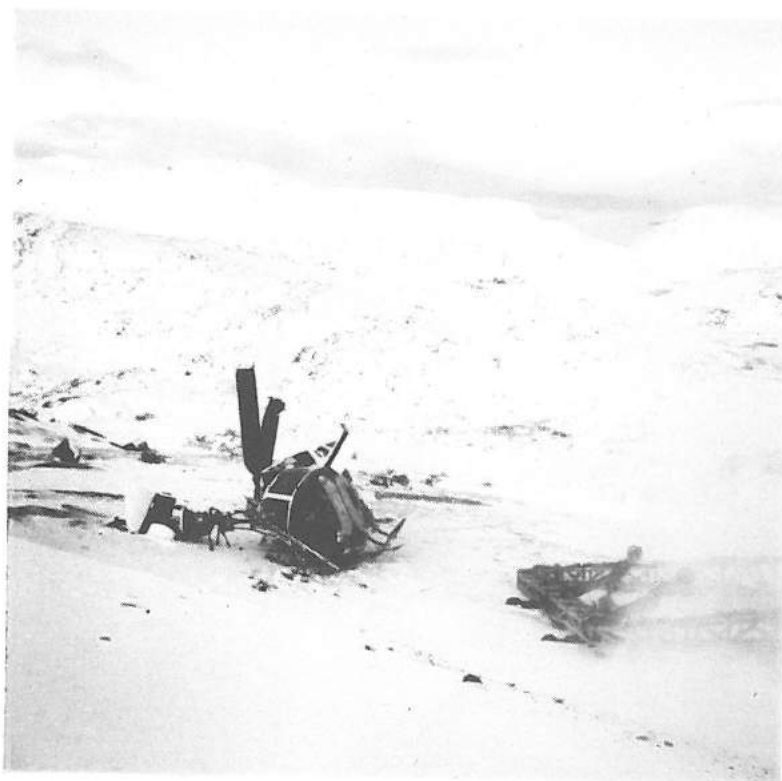
Bild 5. Helikoptervraket i viloläge efter nedslaget. Observera snöröken vid lasten som just slagit i marken.
