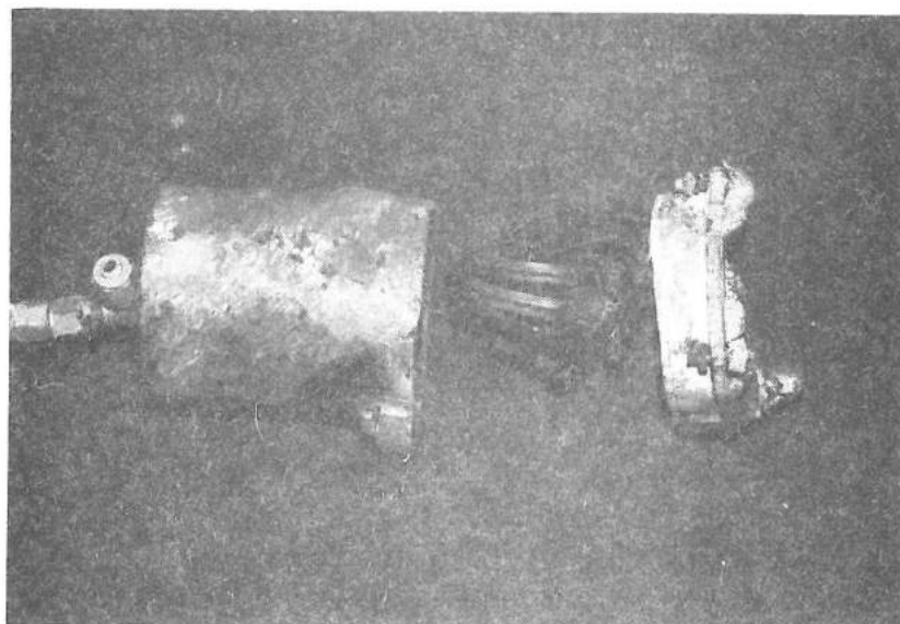
Fig 6 Bilden visar hur membranheten böjts bort från visarenheten
