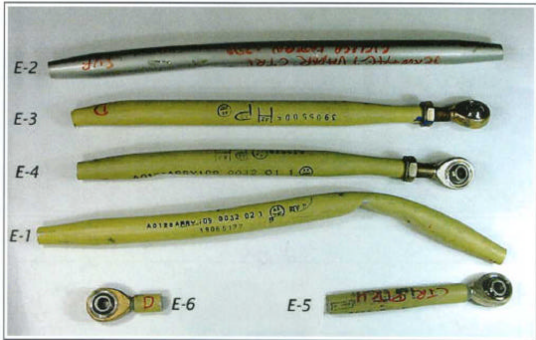
Fig 1.- Elementos cuya configuración parece indicar que corresponden a varillas tubulares de mando
