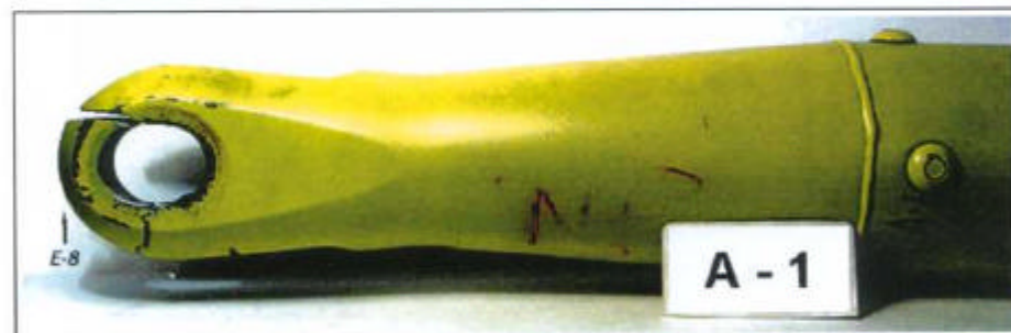
Fig. 17.- Fragmento E-8 acoplado en el tornapuntas A-1 del que procedía
