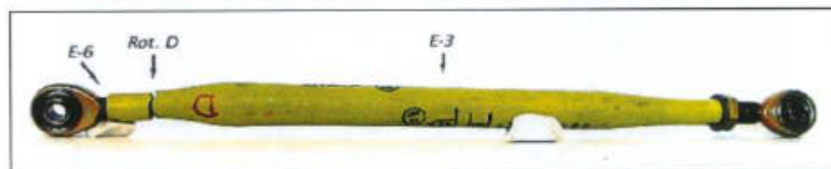
Fig. 16.- Varilla tubular de mando formada por los elementos denominados E-3 y E-6
