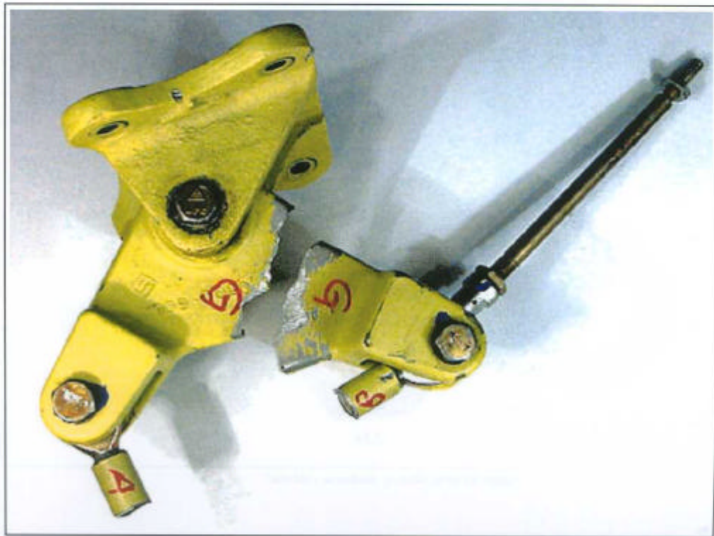
Fig. 2.- Conjunto de la placa de reenvío de mandos del rotor principal y el soporte articulado de la misma
