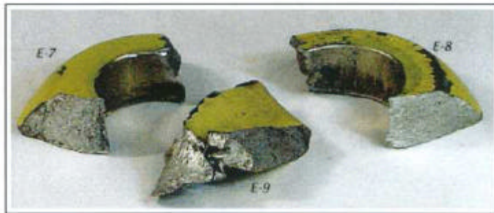
Fig. 13.- Fragmentos, dos procedentes de las orejetas de los tornapuntas (Fig. 9) y el tercero, no identificado
