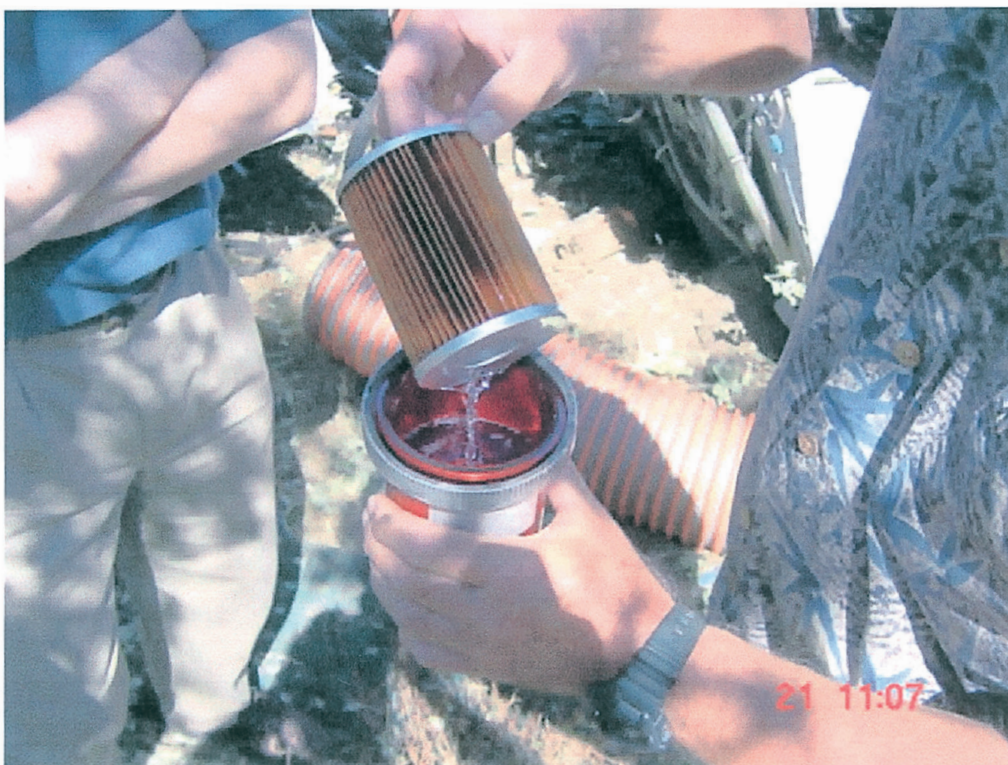
Verifica pulizia filtri carburante
