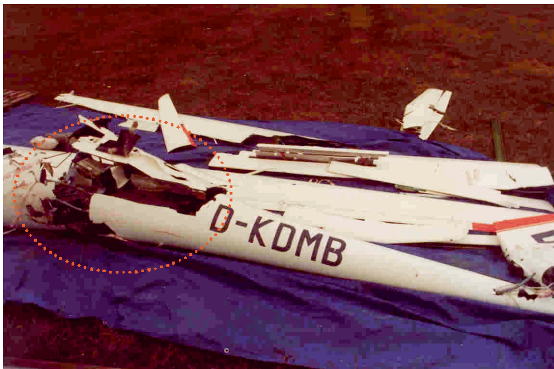
Resti motore. Notare la rottura nella zona sottostante l'alloggiamento motore
