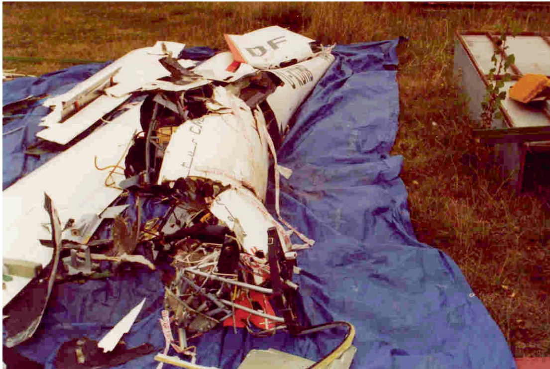
Resti motoaliante. Notare le deformazioni della parte anteriore della fusoliera
