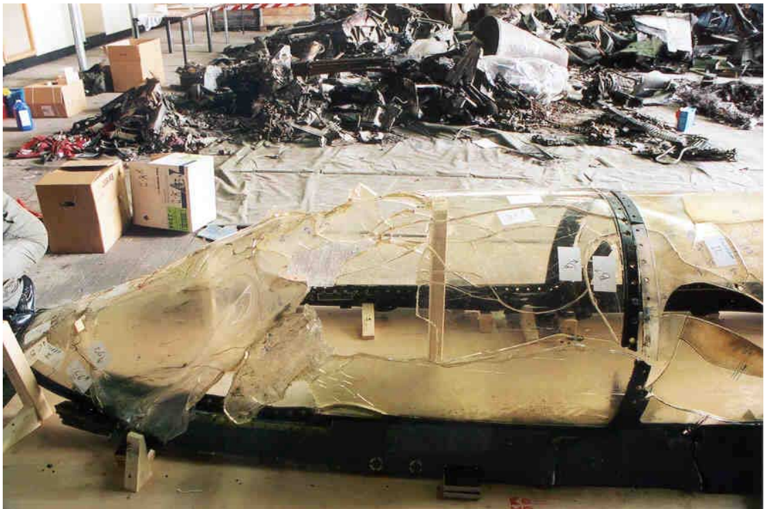
Figuur 3-1: Overzicht gereconstrueerde canopy.
