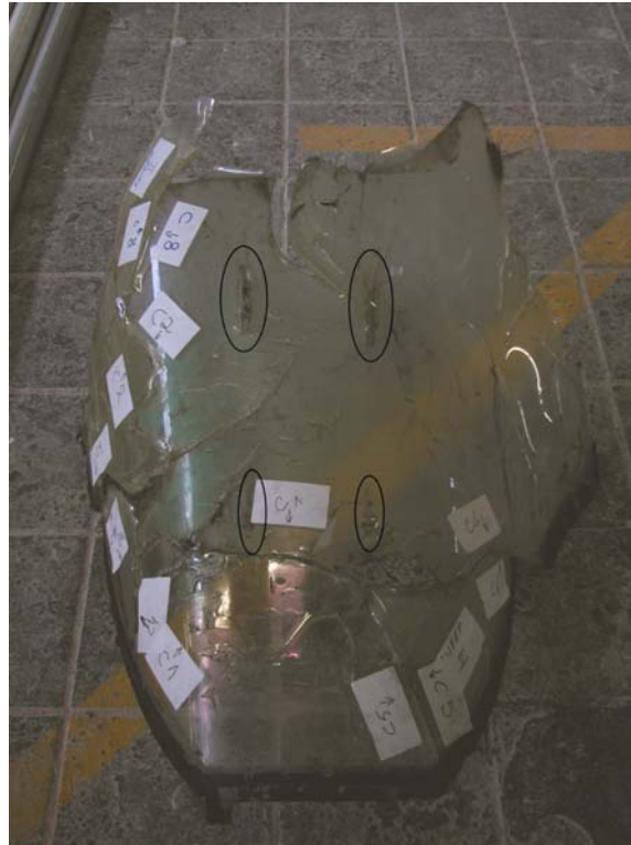
Afb. 8 Indrukken van de HUD in het voorste deel van de canopy.
