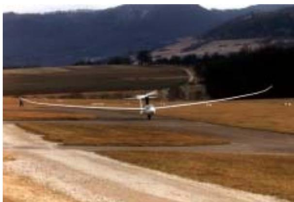
vigore dal 7 maggio 1987. L'aeromobile è dotato di un motore Solo 2350 C, con potenza massima di 20 KW e di un'elica Technoflug KS-132-2-S. Il Ventus cM, per le caratteristiche del suo impianto motopropulsore, è in grado di decollare autonomamente e rientra pertanto nella categoria dei *Self Launching Sailplane*.
