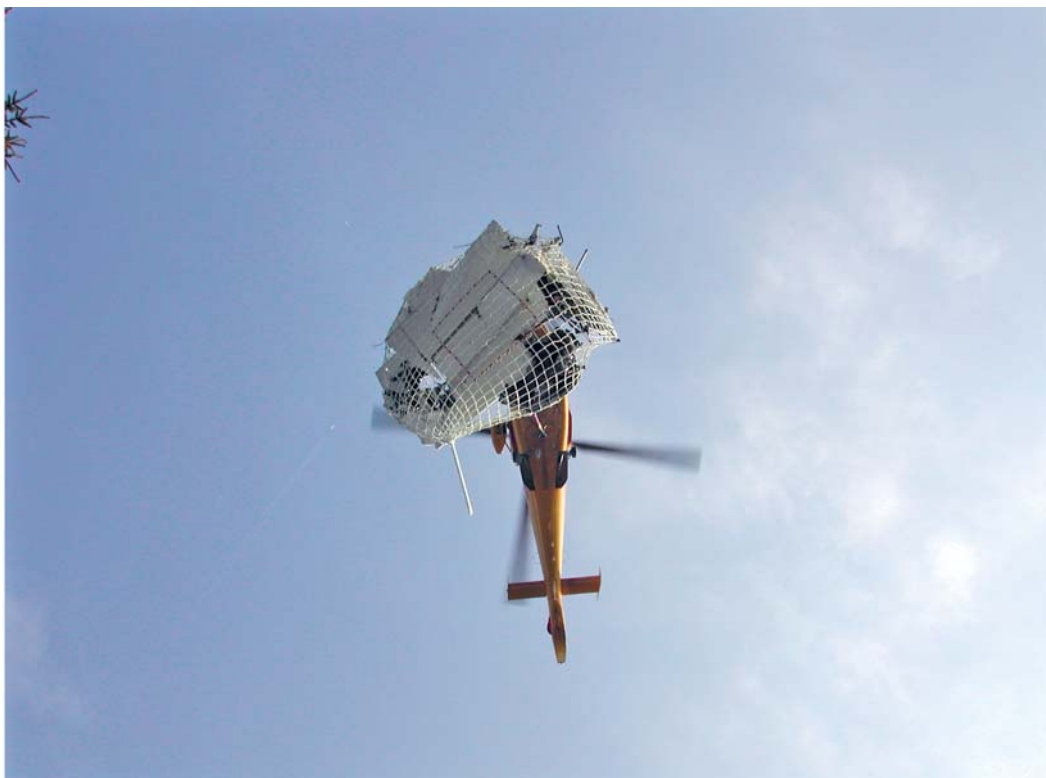
Recupero delle superfici aerodinamiche, dei portelli e delle lamiere di rivestimento.
