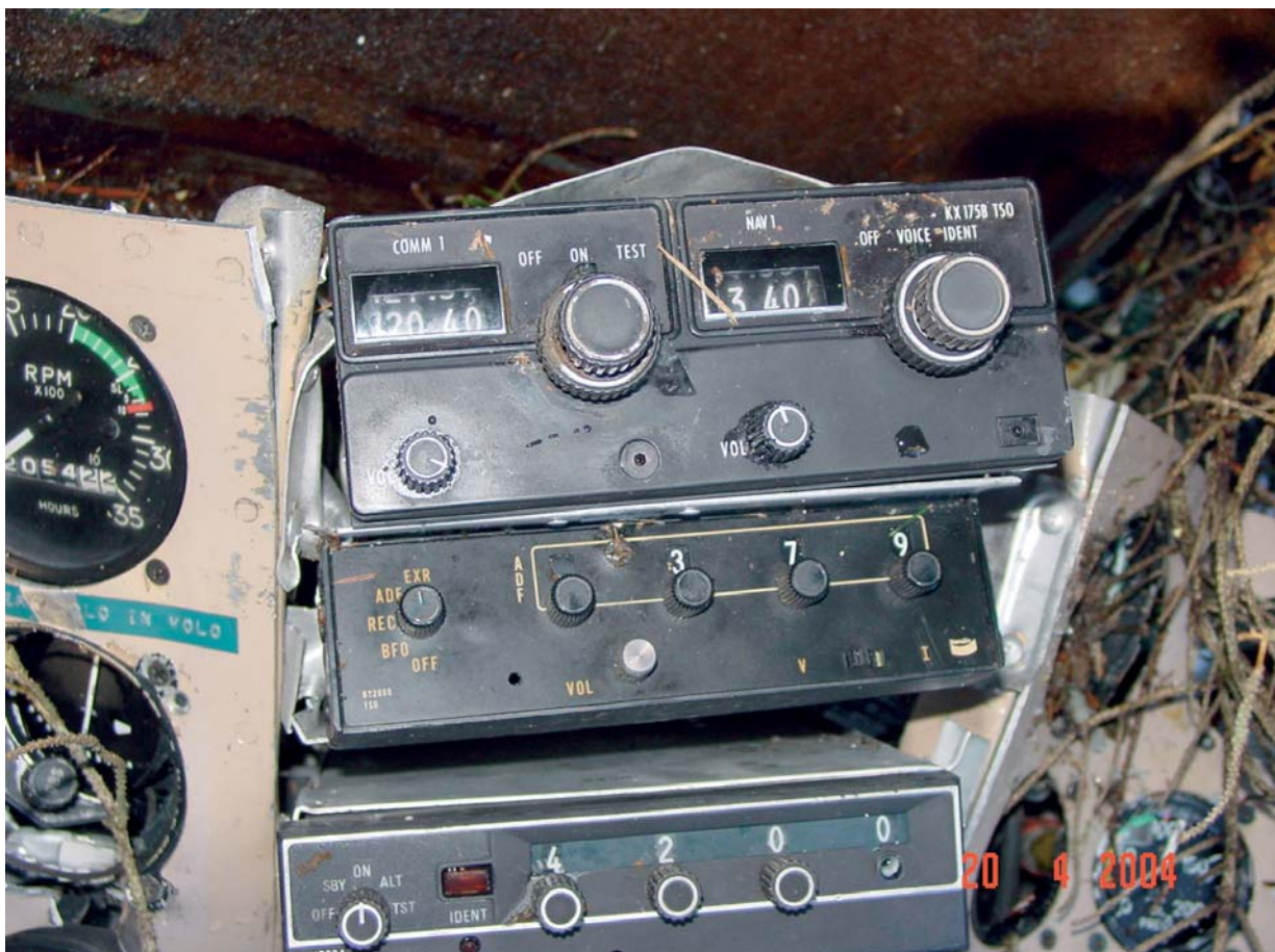
Foto n. 4: apparati di comunicazione e radionavigazione trovati a bordo dell'I-IABT; l'ultimo in basso è il transponder.
