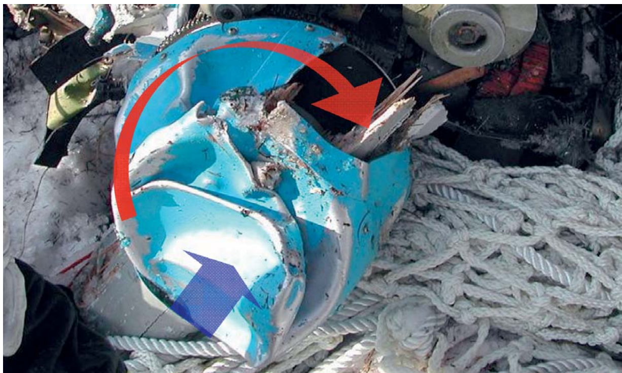
Foto n. 10: deformazioni ogiva motore.
