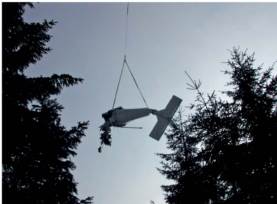
Recupero del tronco posteriore di fusoliera.
