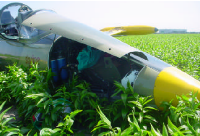
Het openstaande luik na het ongeval
