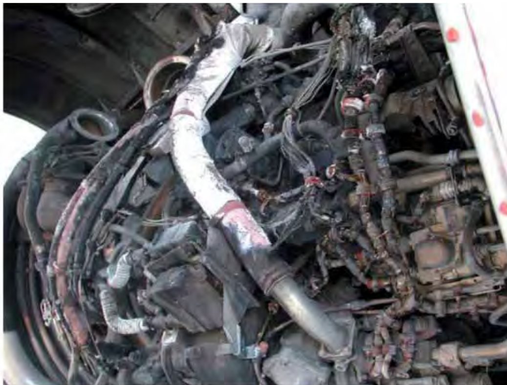
Parte esterna motore destro. Notare i residui di colore bianco sulle tubazioni dovuti al liquido estinguente delle fire bottles .
