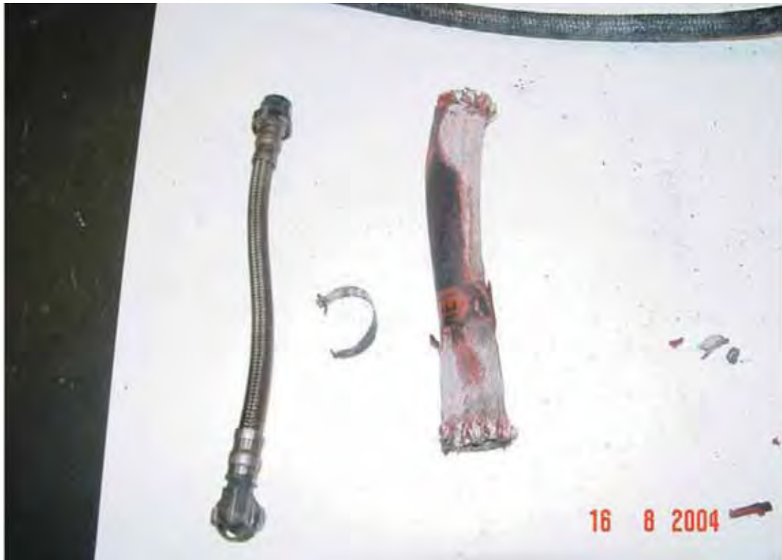
Particolare foro nella tubazione in teflon.
