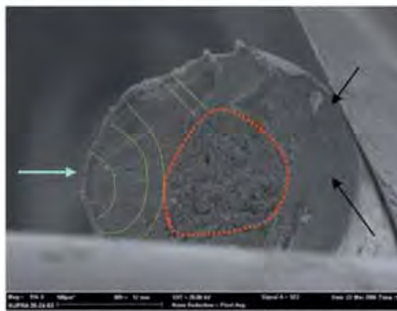
Figura 6– superficie di rottura di un filo
