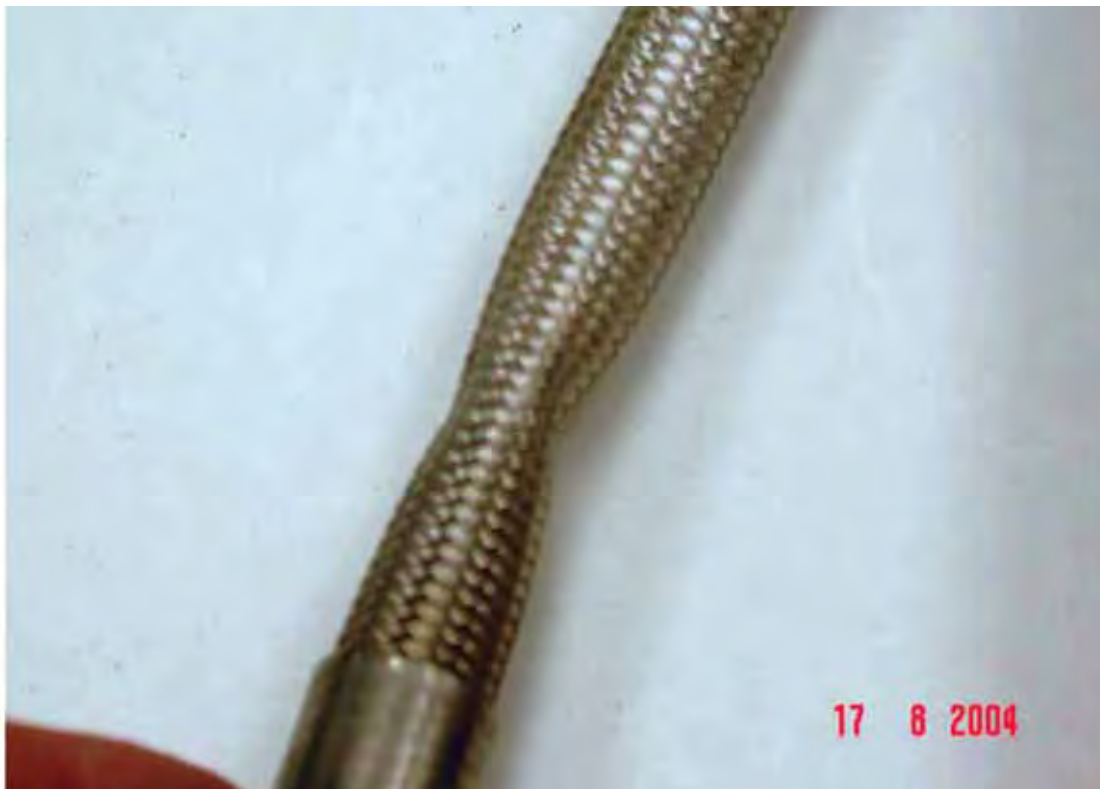
Tubazione CP11 prelevata da un altro motore PW 4062. Particolare deformazioni.
