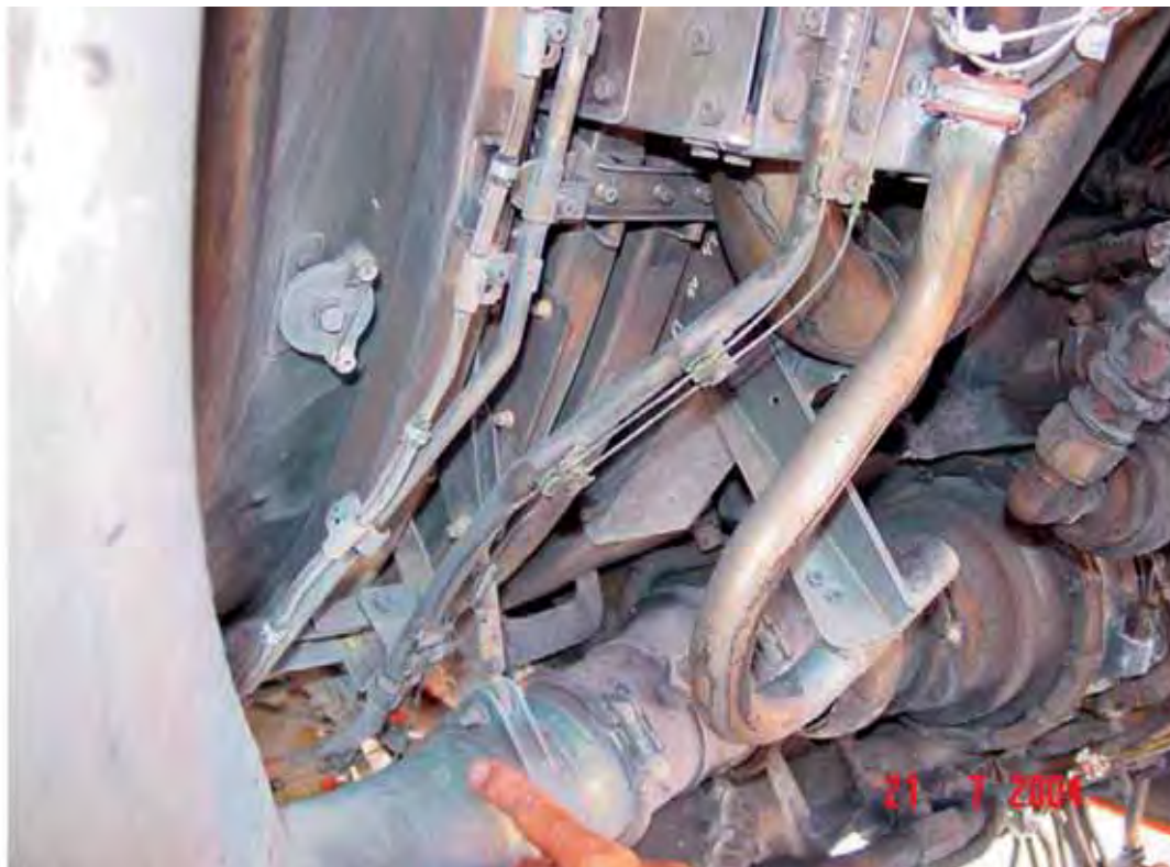
Sistema Fire Detection motore destro, danneggiato a seguito dell'esplosione e del relativo incendio.
