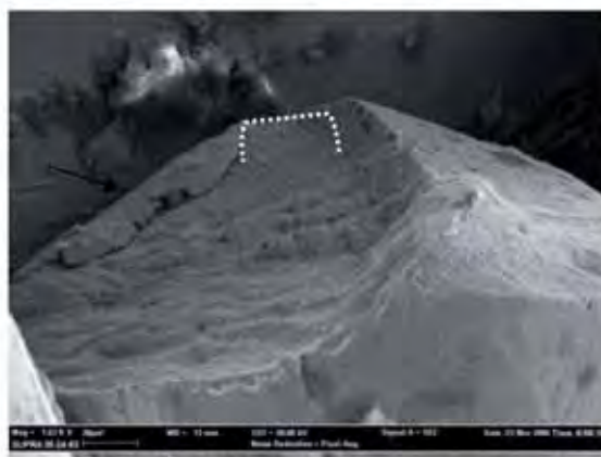
Figura 17 - particolare superficie di rottura di un filo
