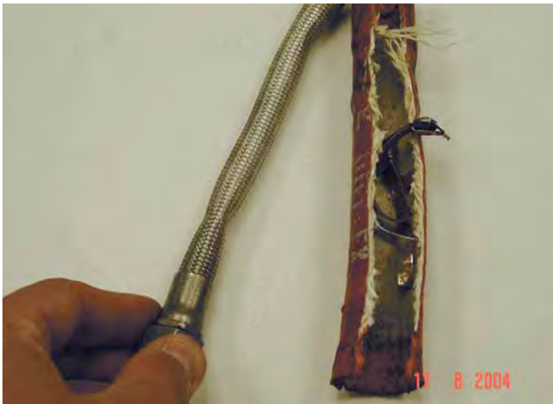
Tubazione CP11 prelevata da un altro motore PW 4062. Le deformazioni presenti sono state indotte intenzionalmente piegando la tubazione con le mani d'agendo con il pollice su di essa come punto di vincolo.
