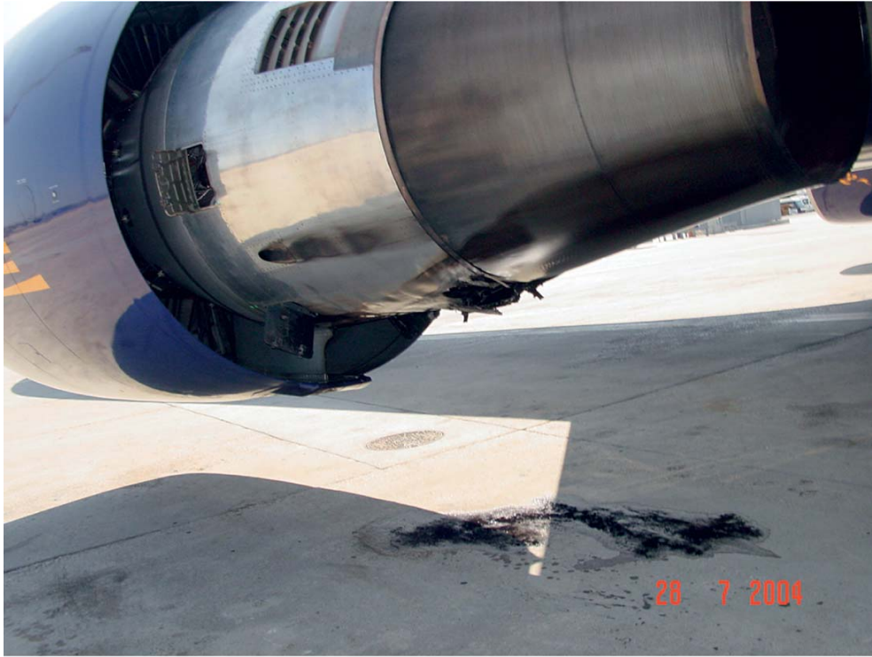
Motore sinistro: notare i danni nella parte inferiore.
