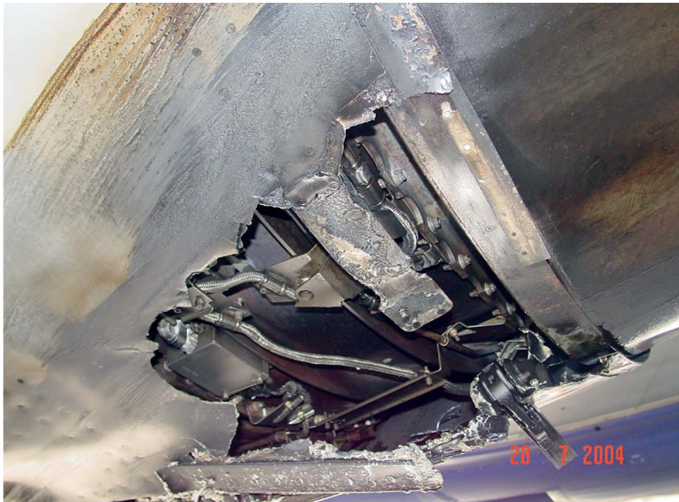
Motore sinistro: particolare danni esterni.
