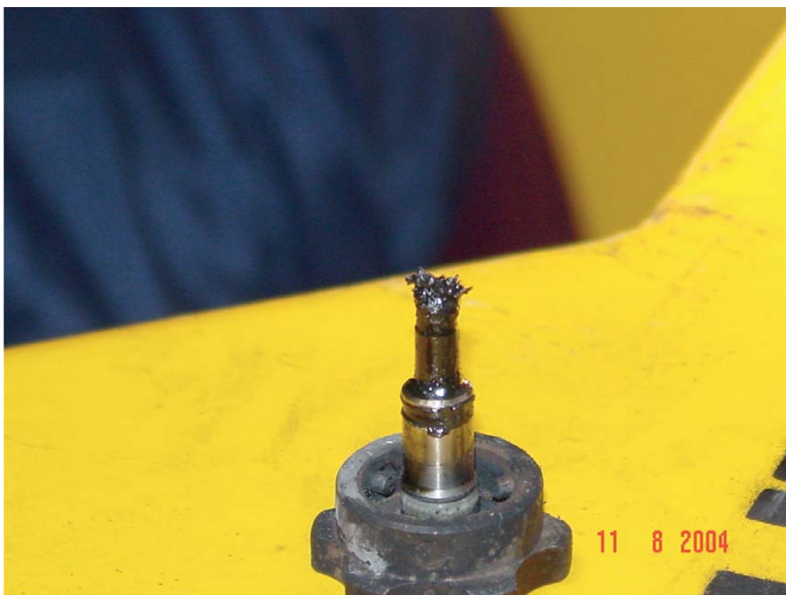
Magnetic Chip Detector (MCD) relativo al cuscinetto N. 3.
