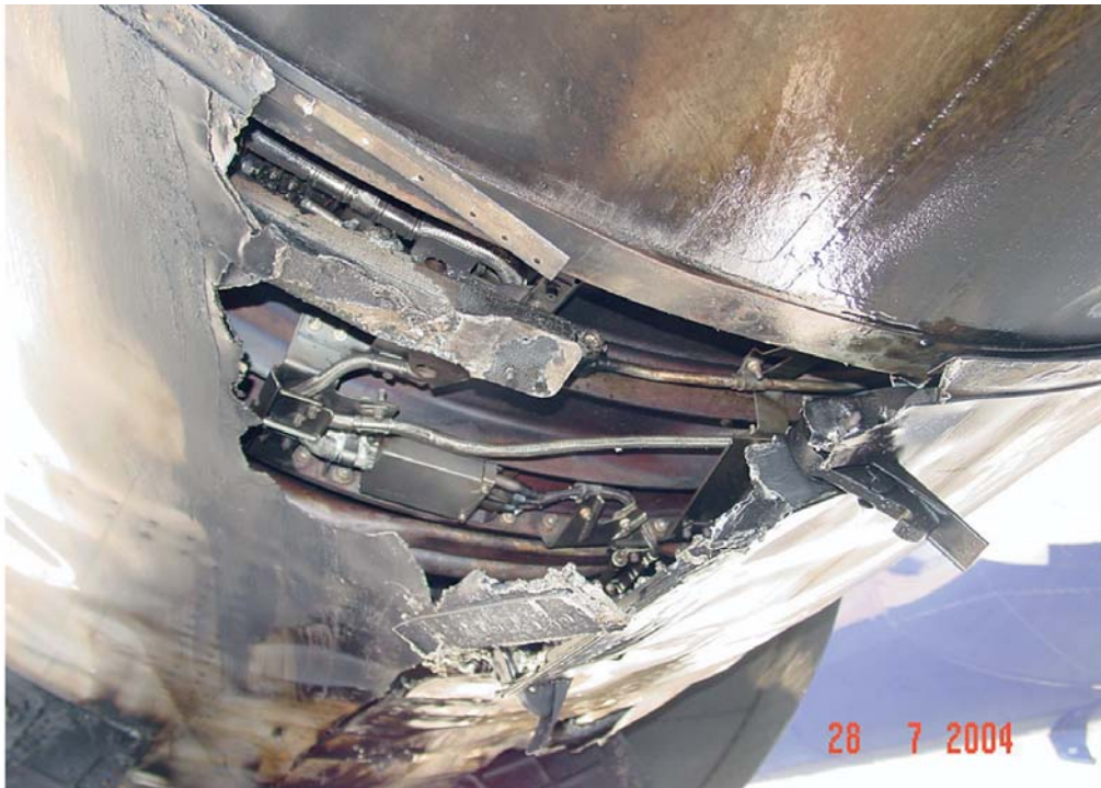
Motore sinistro (particolare danni esterni).
