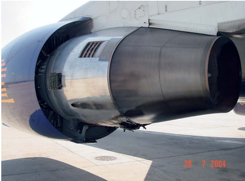
Motore sinistro (notare danni parte inferiore).
