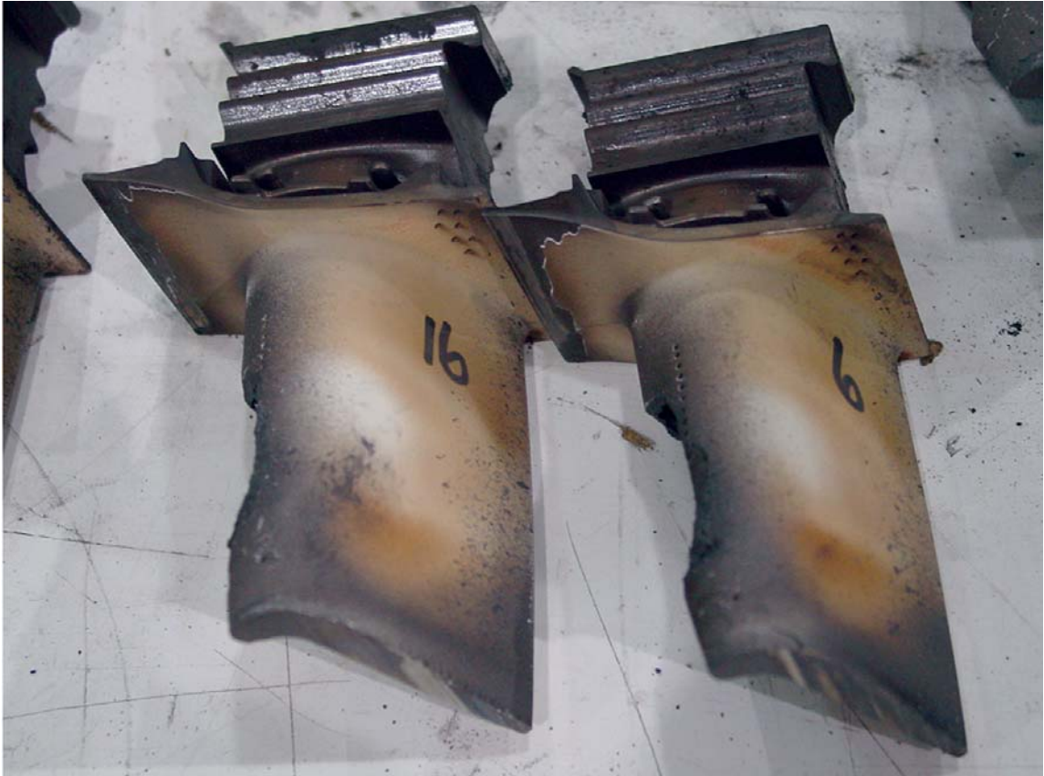
Palette primo stadio turbina alta pressione.
