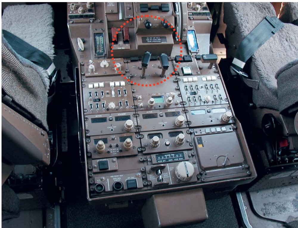
Piantana centrale cabina di pilotaggio: notare, nel riquadro, la leva sinistra ruotata verso destra, ad indicazione dell'azionamento della seconda scarica di estinguente.
