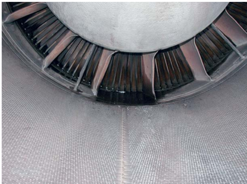
Particolare cono di scarico del motore sinistro: notare la chiazza di olio.
