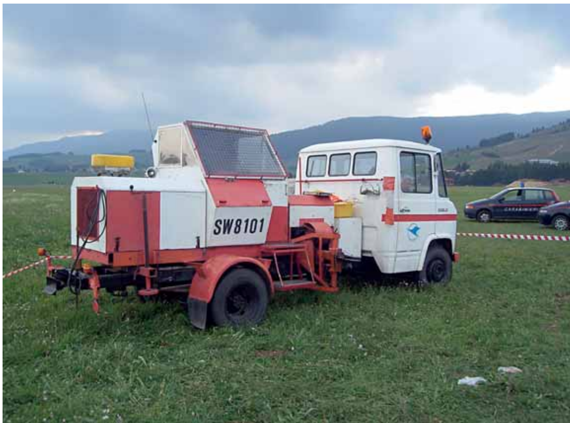
L'autocarro su cui è installato il sistema del verricello. Notare la cabina del verricellista. Subito dopo l'incidente l'autocarro è stato posizionato in prossimità del relitto, al fine di circoscrivere l'area sottoposta a sequestro da parte della competente Autorità giudiziaria.
