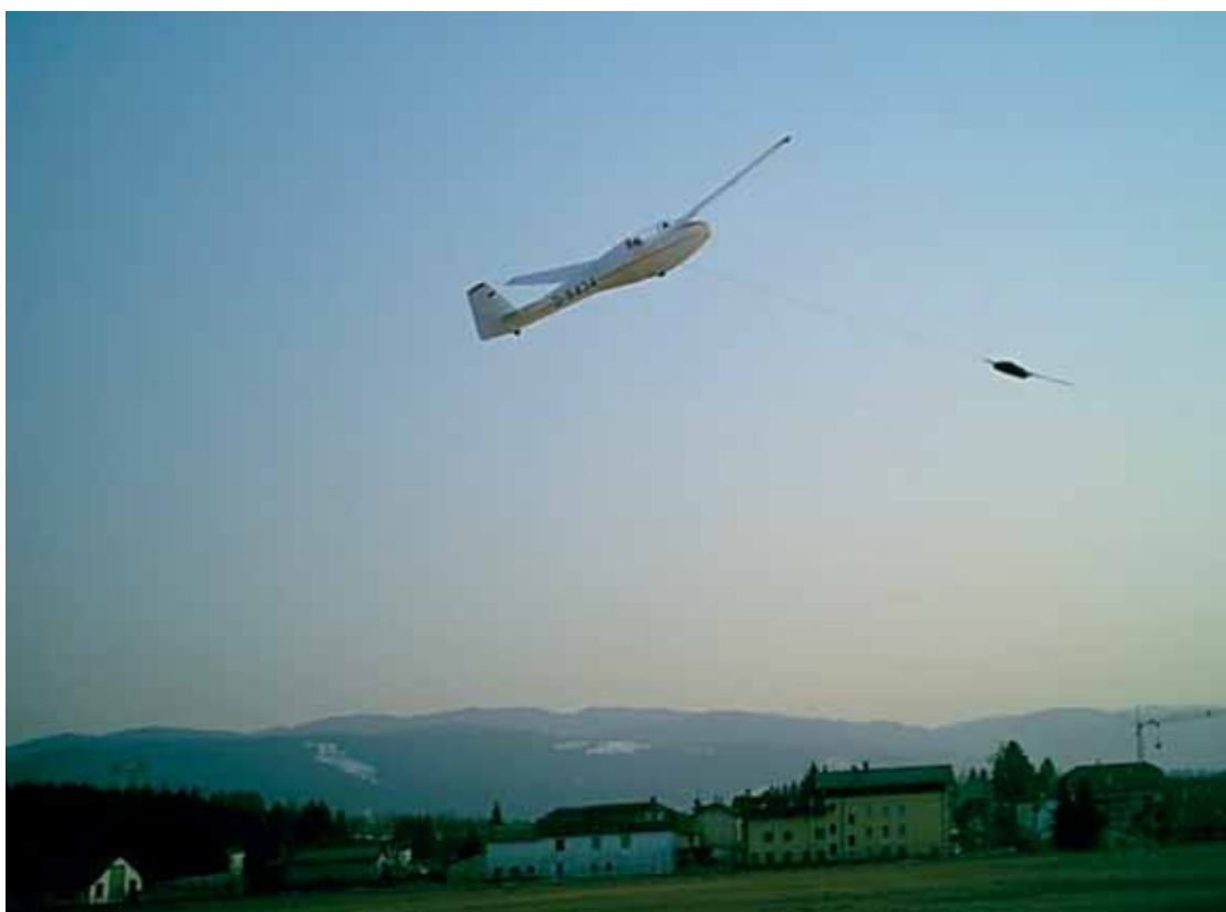
Lanci al verricello sull'aeroporto di Asiago. Notare il cavo di traino con il paracadute per il recupero del cavo e l'assetto dell'aliante.
