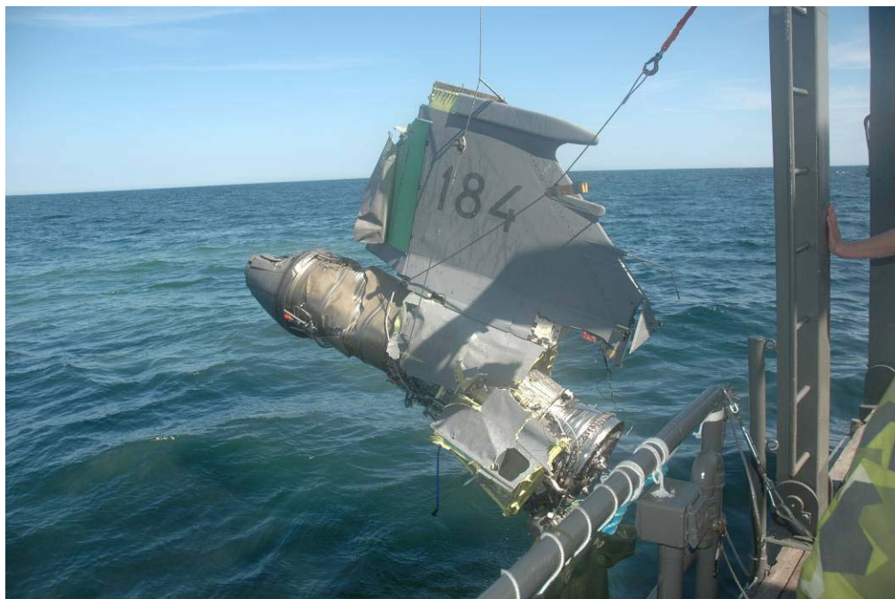
Fig. 12: I främre delen av fenans undersida kan det rödmålade kraschskyddade minnet (KSM) observeras
