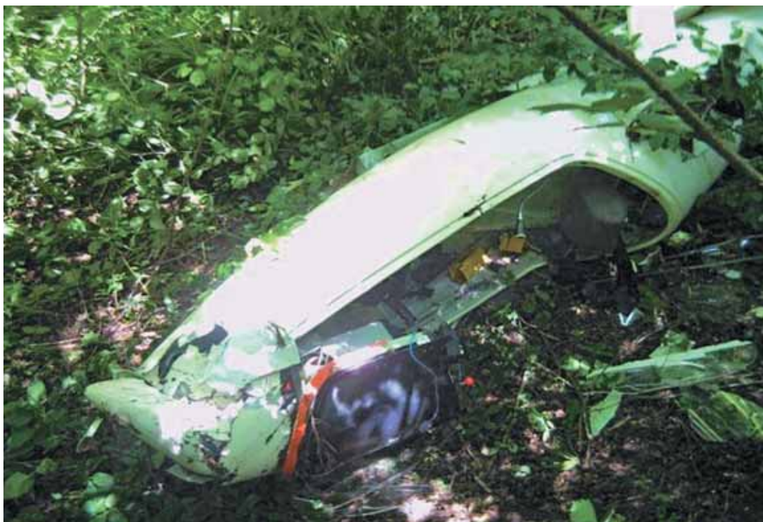
Parte anteriore della fusoliera dopo l'impatto.
