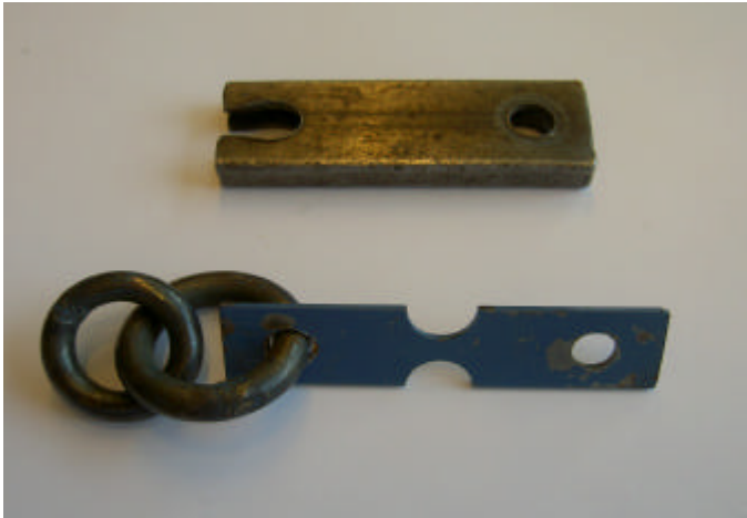
Foto 1: Boven een breukstukhouder en daaronder een blauw breukstuk, zoals gebruikt werd tijdens de ongevals-vlucht.
