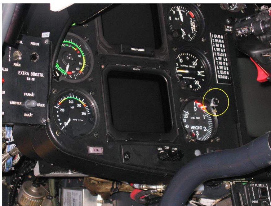
Fig. 09: Även 2. pilotens RHM var försett med en osanktionerad modifiering med ett vitt buntband på Till-/Frånvredet - markerat med gul cirkel.
