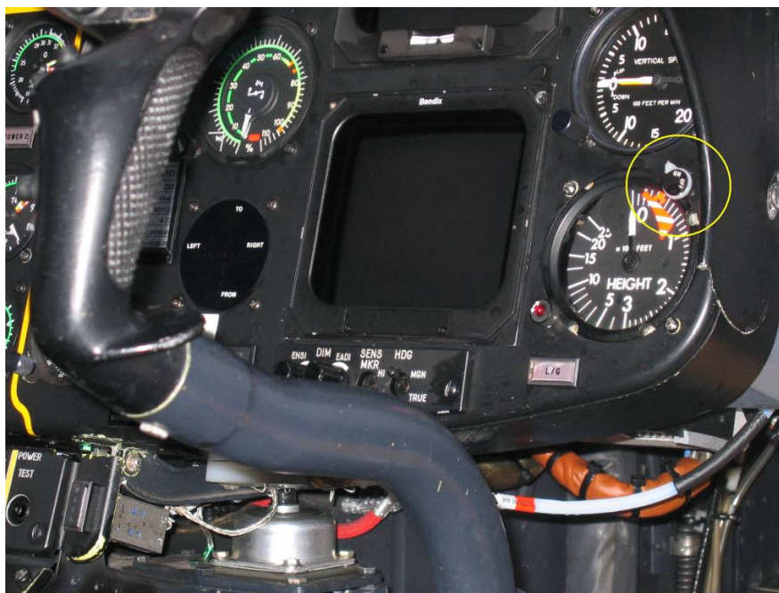
Fig. 08: 1. pilotens radarhöjdmätare (RHM) är det understa instrumentet längst till höger på instrumentpanelen. Den osanktionerade modifieringen med ett vitt buntband kan ses på Till-/Frånvredet - markerat med gul cirkel.
