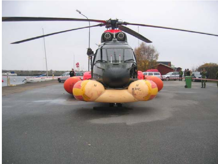
Fig. 02: Helikoptern med uppblåsta nödflottörer.
