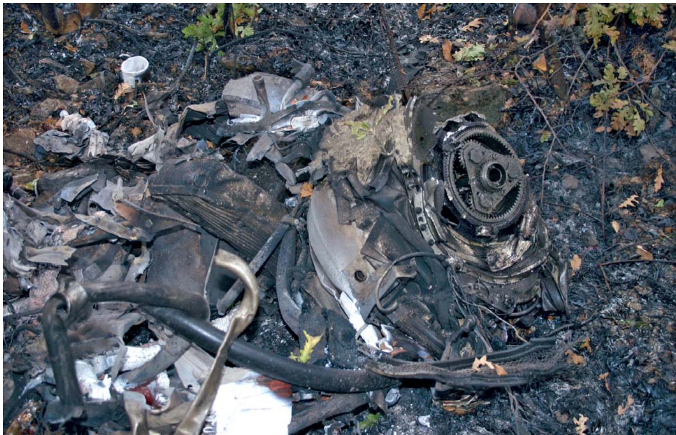
Vista lato riduttore motore sinistro.
