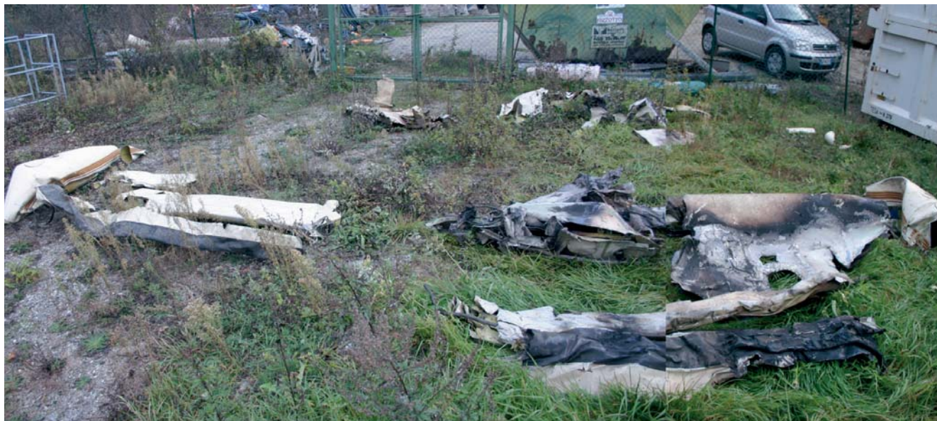
Rottami di più grandi dimensione struttura alare destra.
