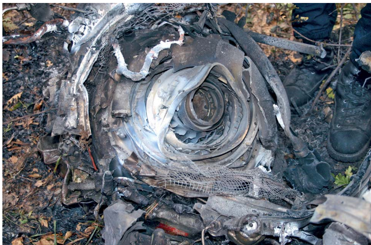
Vista lato turbina motore sinistro.
