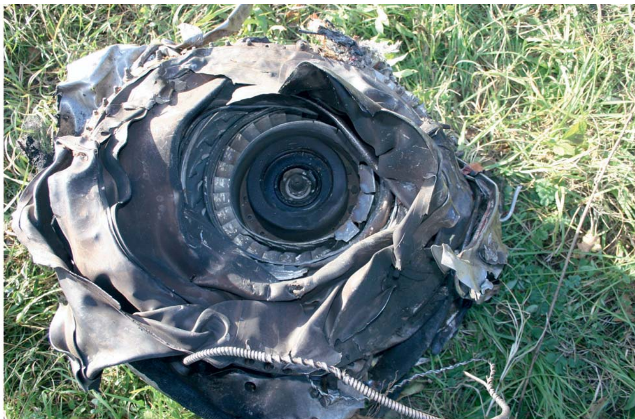
Vista turbina e camera combustione motore destro.
