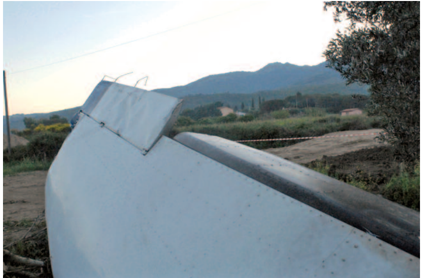
Foto n. 5: flap semiala destra in posizione estratta.
