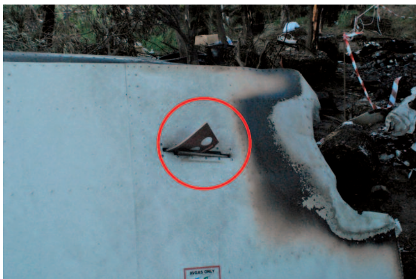
Foto n. 4: freno aerodinamico semiala destra.
