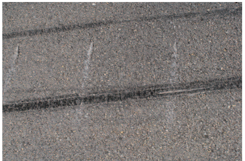
Foto n. 7: tagli lasciati sulla pista dalle pale dell'elica.
