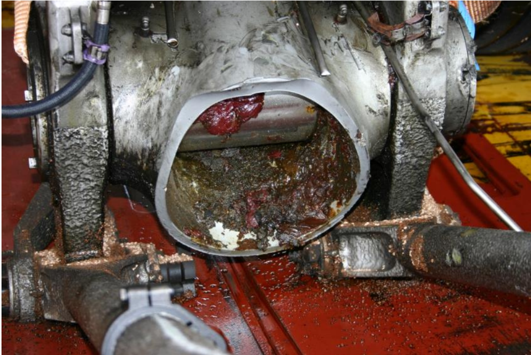
Abbildung 2: Vorderer Teil des Fahrwerkträgers mit Gelenkbolzen
