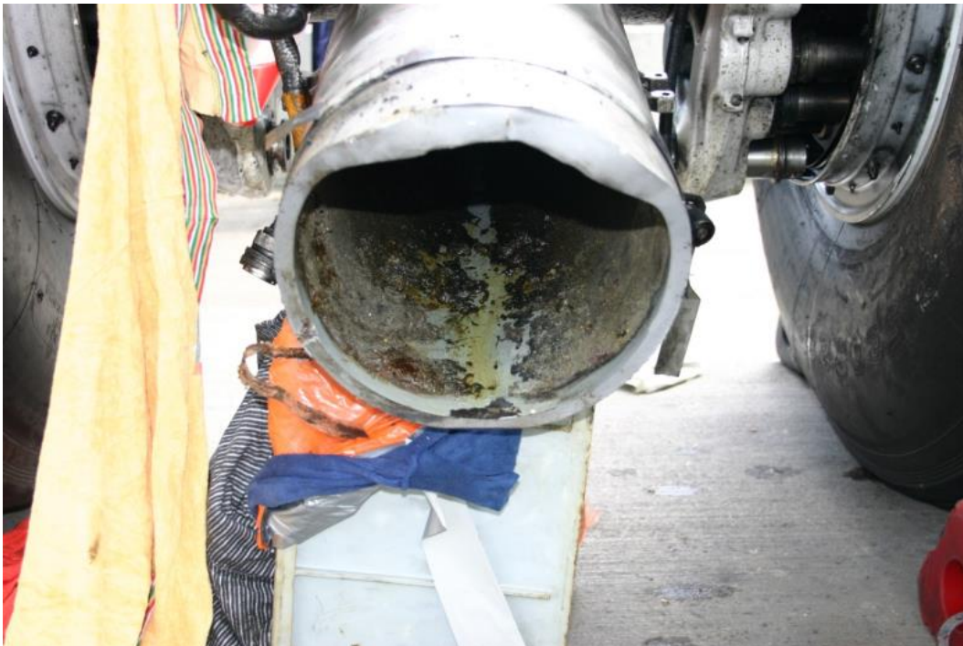
Abbildung 3: Hinterer Teil des Fahrwerkträgers mit hinterem Räderpaar
