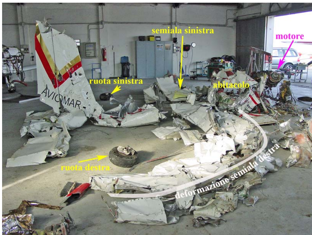
Foto 9: ricostruzione del relitto del velivolo all'interno di un hangar.
