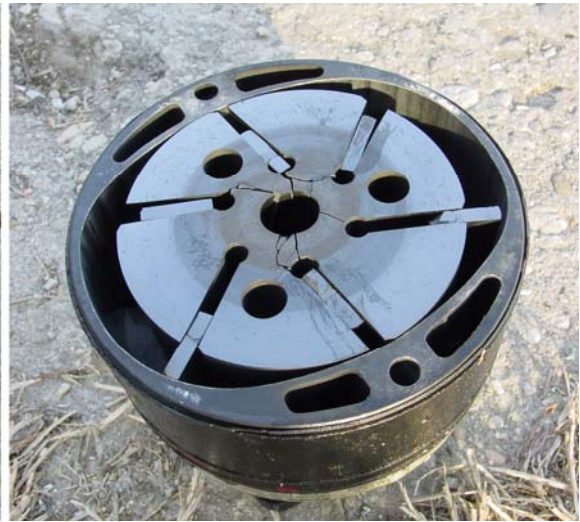
Foto 13: rotore interno pompa vacuum.
