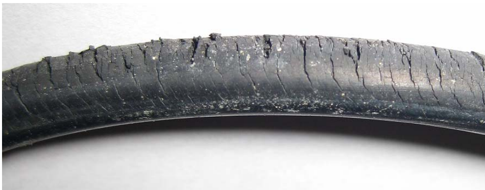
Fig. 4. O-ring vid höger tanklock.
