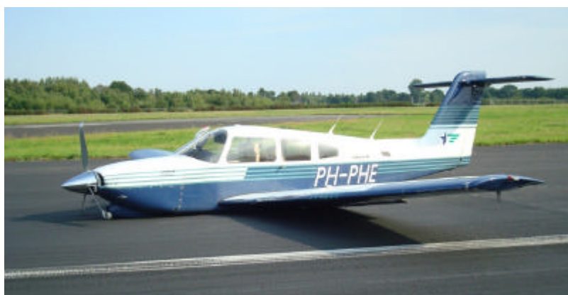
Figuur 1: PH-PHE na de buiklanding op baan 05 van Groningen Airport Eelde
