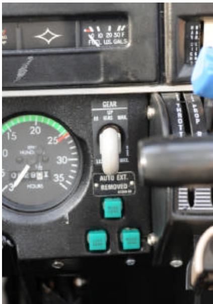
Figuur 2: Landingsgestelhendel en indicatielampjes, gefotografeerd na de buiklanding
