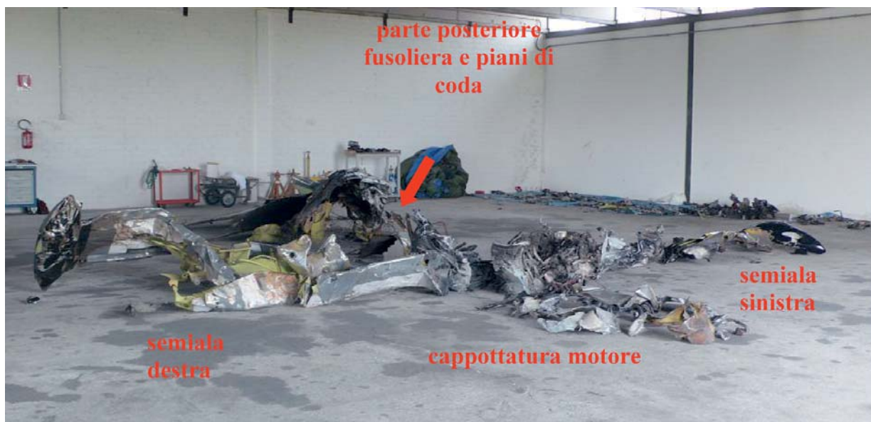
Foto n. 8: ricomposizione del relitto.
