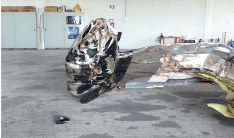
Foto n. 20: deformazioni da impatto della superficie inferiore dell'estremità alare.
