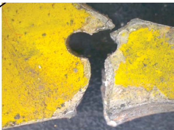
Foto n. 19: ovalizzazione foro e deformazioni plastiche (particolare della foto n. 18).
