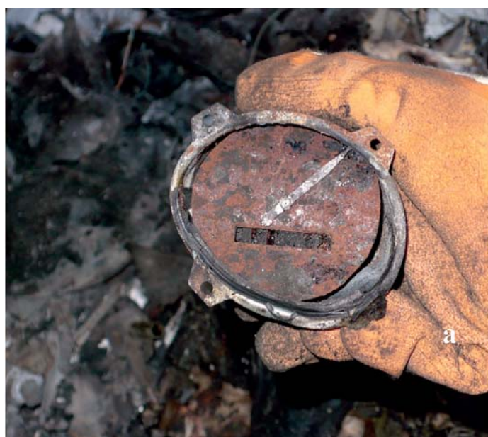
Foto n. 29: contagiri del motore. Notare la lancetta bloccata sui 2500 RPM (a), come si evince dalla scala graduata di un indicatore integro (b).
