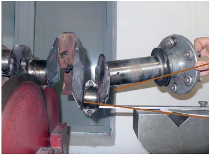
Foto n. 30: deformazioni albero motore.
