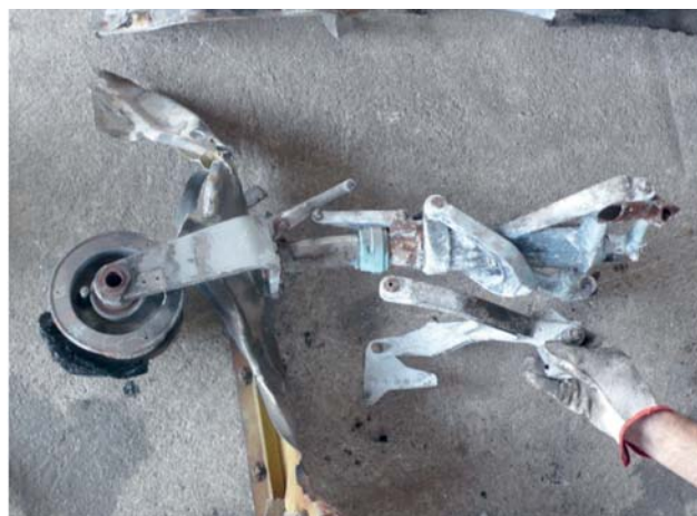
Foto n. 14: rottura del carrello anteriore.
