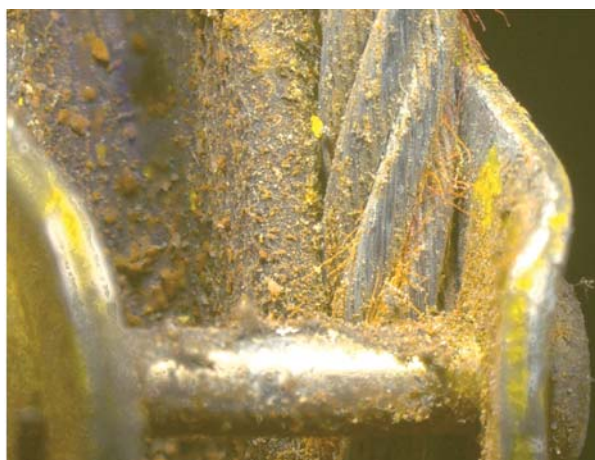
Foto n. 26: cavo comandi di volo fuoriuscito dalla sua sede di alloggiamento.
