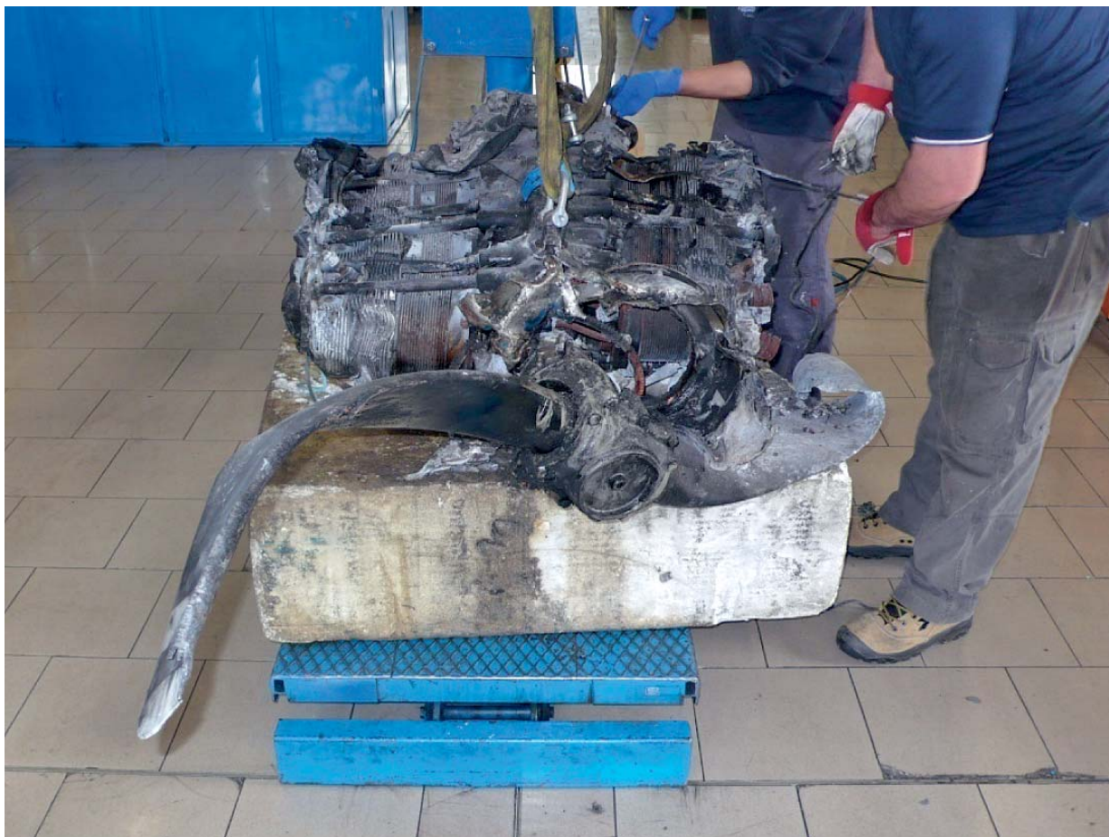
Foto n. 28: complessivo elica-motore. Notare il disallineamento dell'albero motore.
