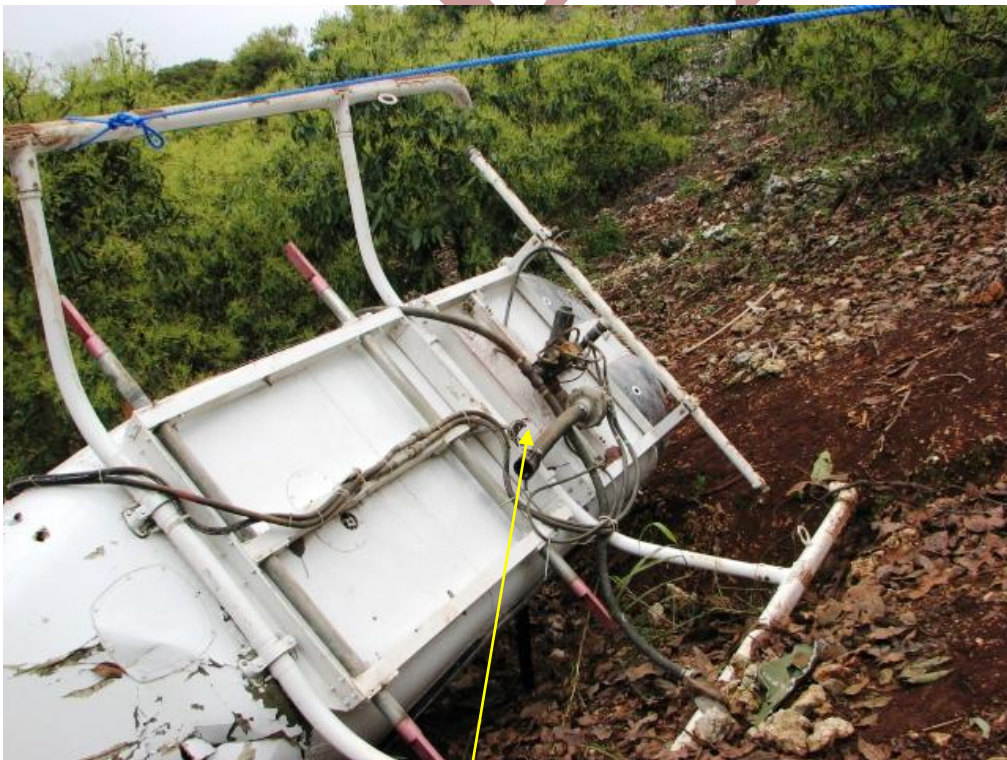
Condición en la que quedo la aeronave luego de haber rodado por la pendiente, nótese que el sistema de aspersion había sido removido.
