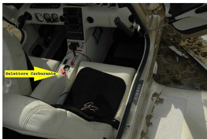
Foto 4: selettore del serbatoio di alimentazione del motore.
