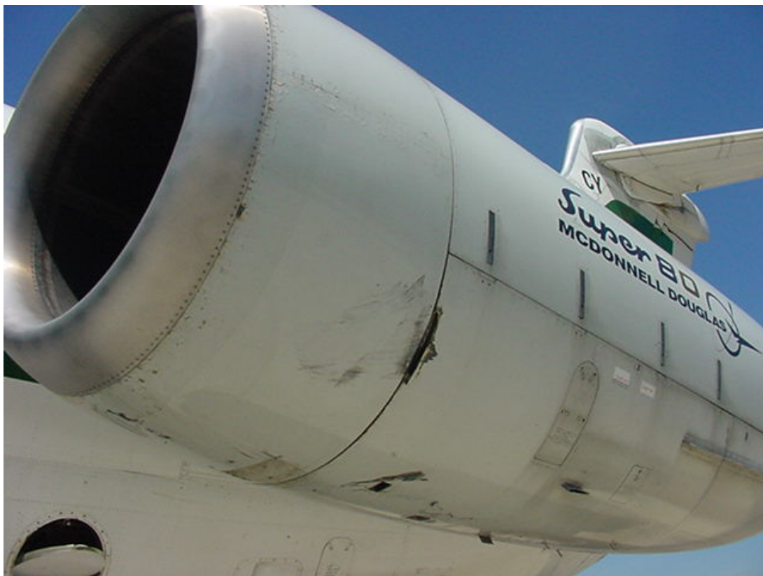
Foto 3: danneggiamenti cappottatura inferiore motore sinistro.
