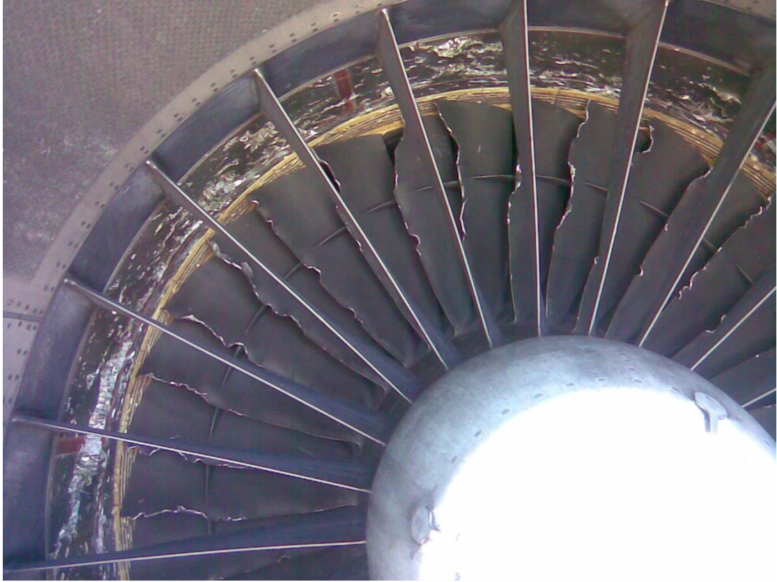
Foto 5: danneggiamenti primo stadio rotorico compressore motore sinistro.
