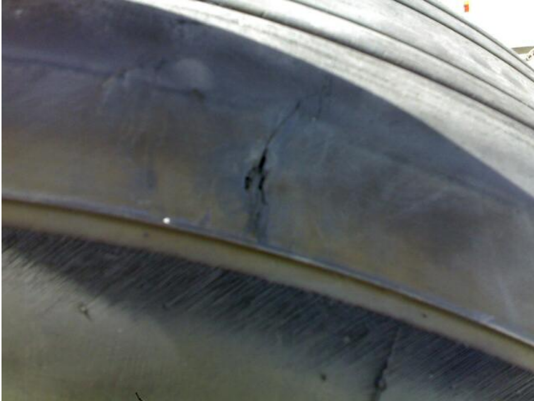
Foto 8: danneggiamento ruota numero 1 carrello sinistro velivolo EC-KBJ.
