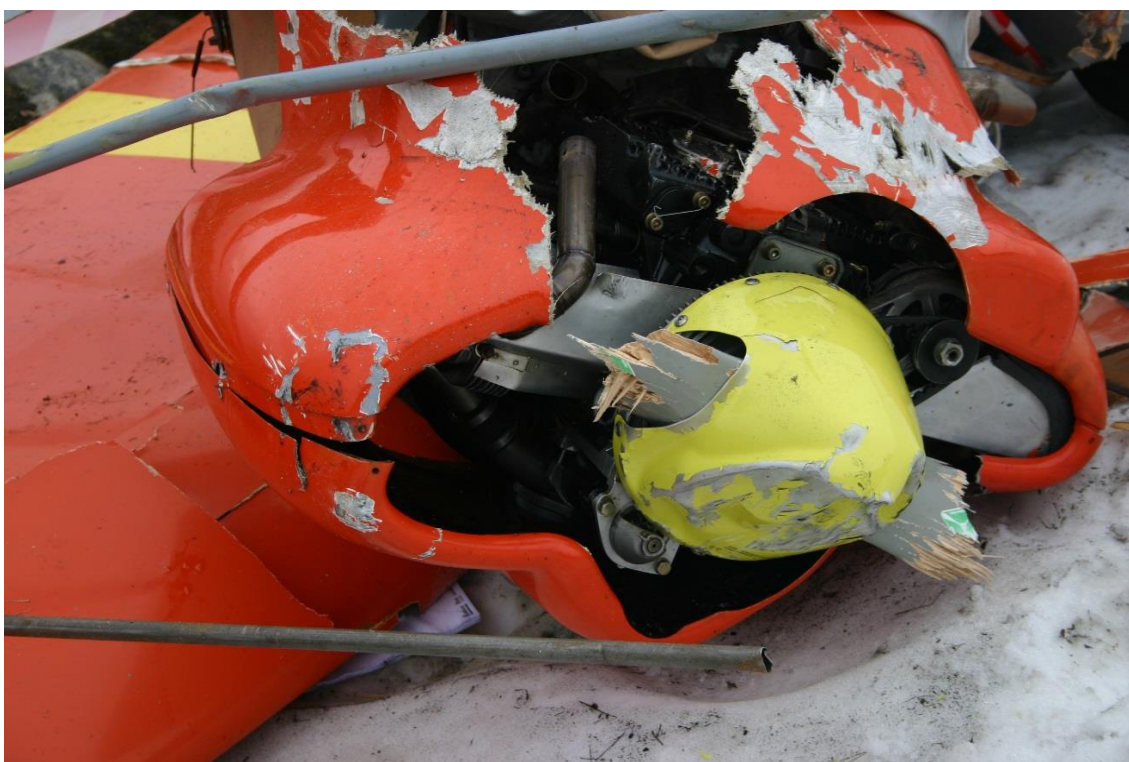
Foto 14: rottura pale dell'elica e deformazione dell'ogiva.
