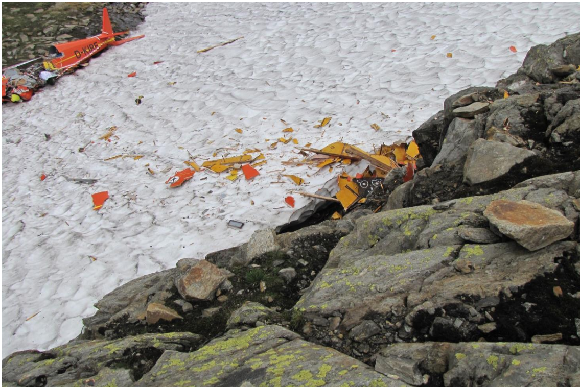
Foto 7: dettaglio della roccia di impatto e rottami della semiala sinistra.
