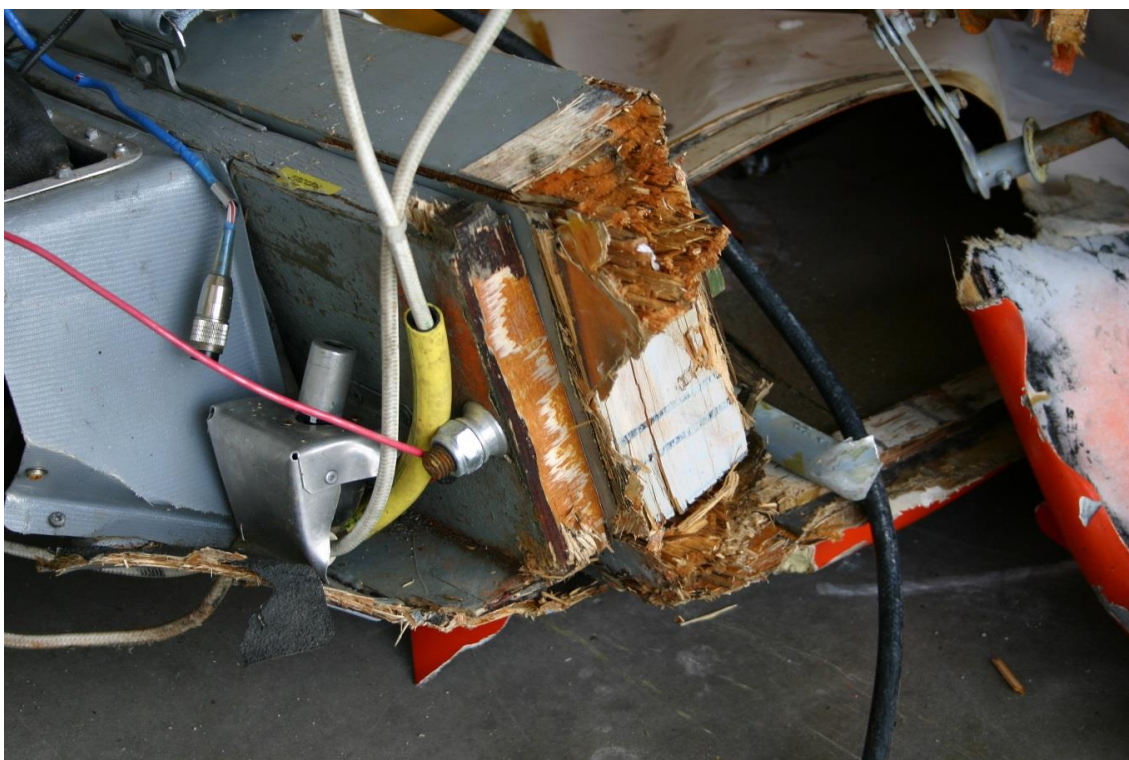
Foto 13: dettaglio della sezione di rottura del longherone semiala sinistra.
