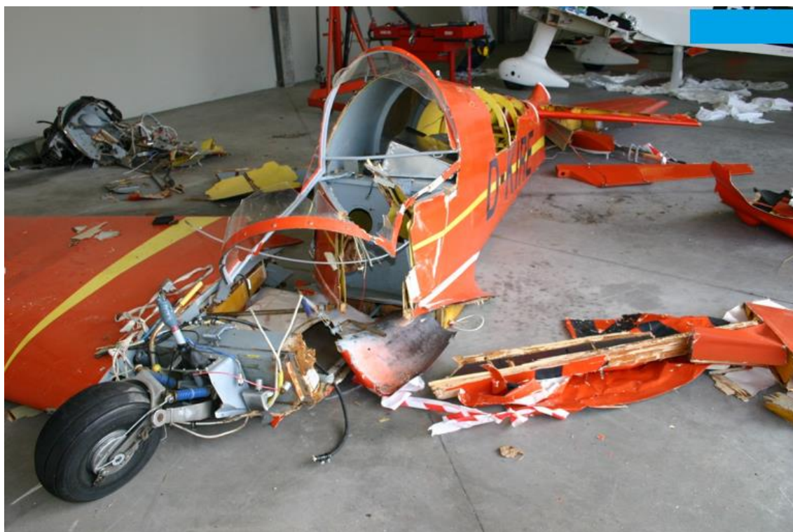
Foto 11: dettaglio del pianetto di collegamento semiali e della radice della semiala sinistra.
