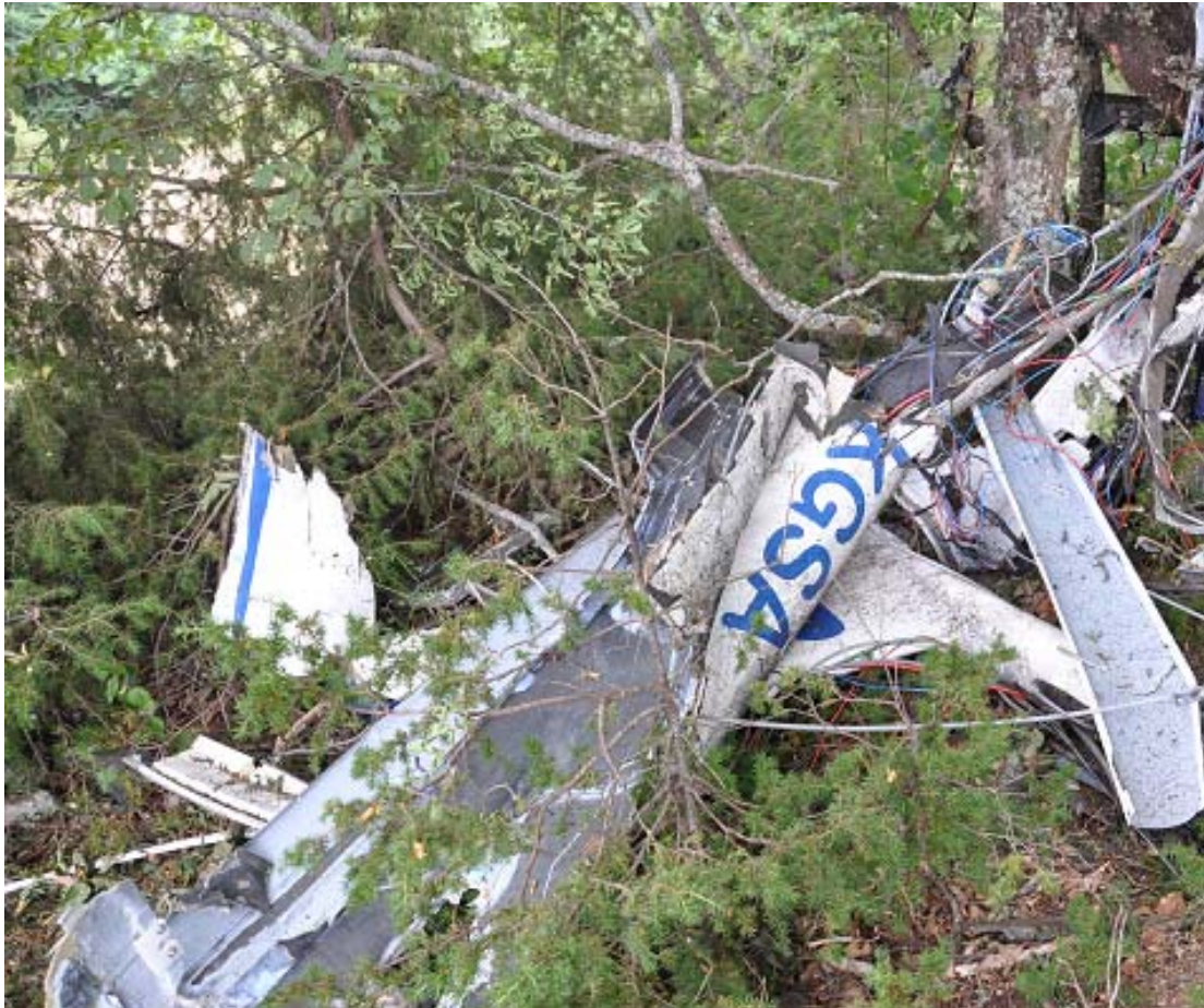
Foto n. 11: posizione troncone di coda e zona centrale di fusoliera dopo l'impatto.
