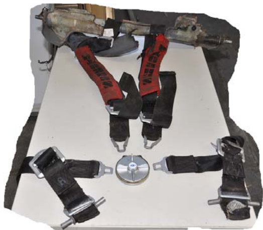
Foto n. 14: cinture svincolate dal blocco centrale.
