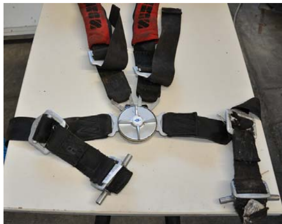
Foto n. 15: cinture vincolate al blocco centrale.
