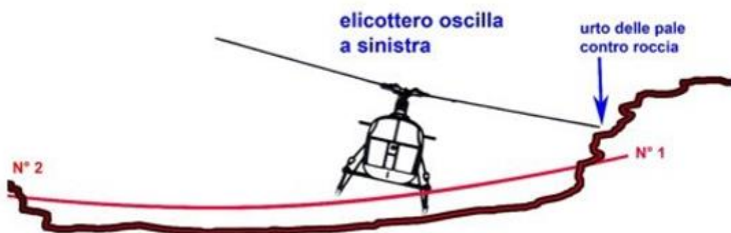
Figura 3: ragionevole ipotesi della dinamica dell'incidente alla luce delle evidenze acquisite.
