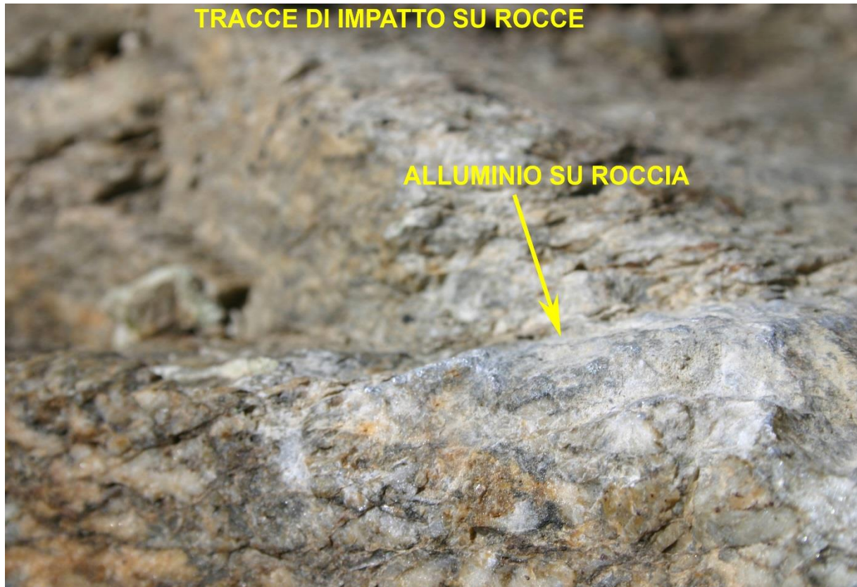
Foto 19: dettaglio di una traccia caratterizzata da alluminio spalmato sulla roccia.
