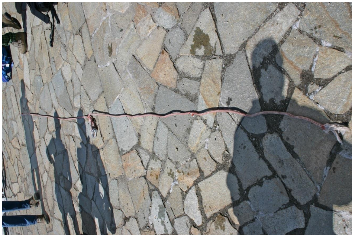
Foto 13: tratto della fune di sicurezza strappato dalle pale del rotore principale.
