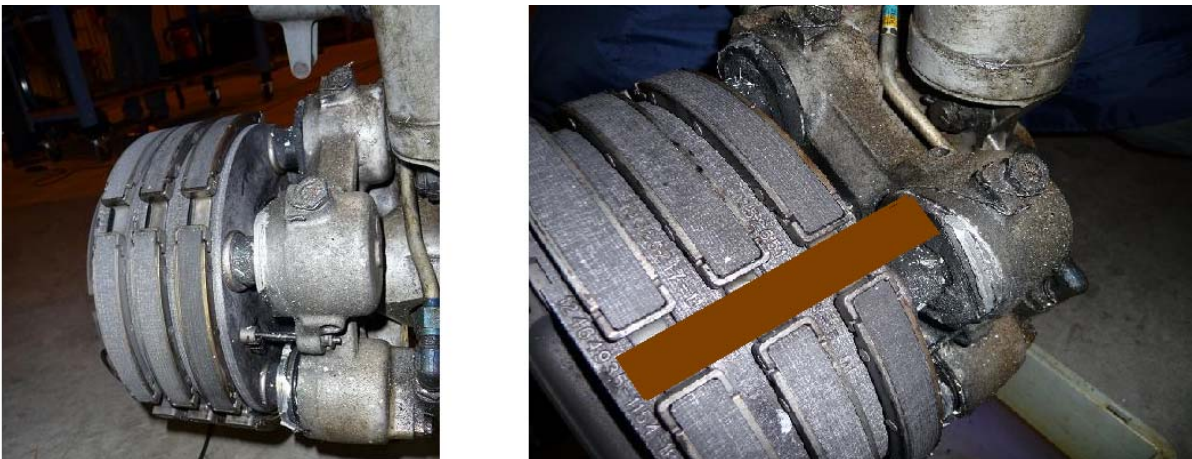
Figuur 7: Schade aan remcilinders van de linkerwielpoot met links de remschijven. Rechts in bruin is schematisch de positie van de "insert" aangegeven op de remschijven. Op de foto is te zien dat wanneer de "insert" lateraal kan bewegen, deze de remcilinders kan raken.
