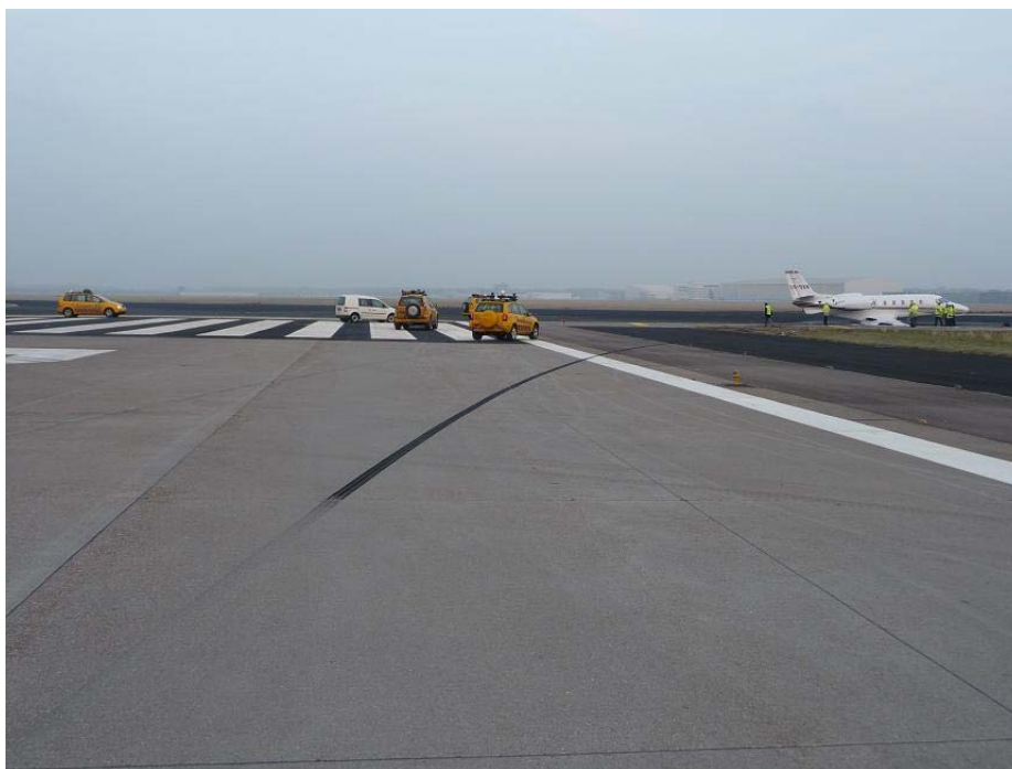
Figuur 4: CS-DXR na voorval met op de voorgrond het remspoor van het rechterhoofdlandingsgestel
