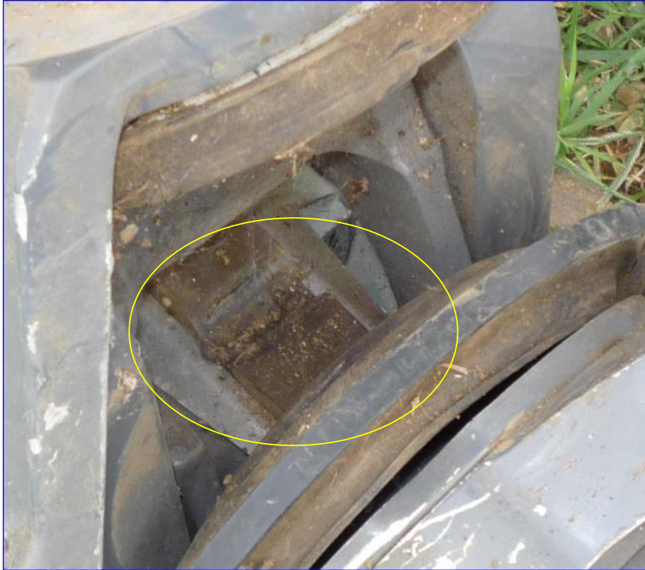
Imagen 08-C.- Transmisión del rotor principal luego de ser recuperada del lugar del accidente. Nótese el tope estático (área señalada por el círculo amarillo) con señales de compresión en el área del centro, evidencia de que había potencia en la aeronave al momento del impacto.
