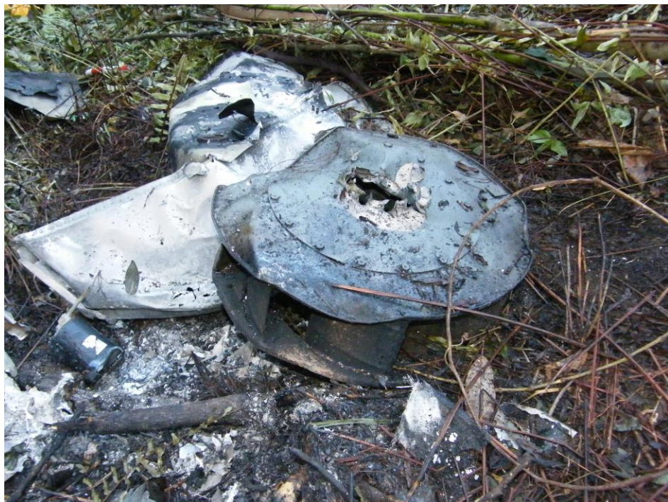
Imagen 07-A.- Fan Wheel de la aeronave, sus restos muestran que estaba operando a un régimen de potencia normal.
