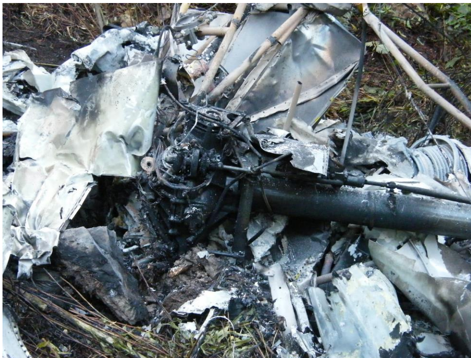
Imagen 04.- Transmisión de la aeronave, nótese el alto grado de deterioro producto del impacto y el incendio post-impacto.
