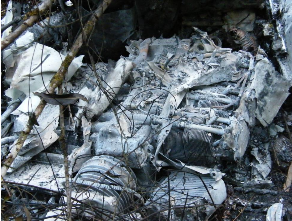
Imagen 06.- Motor de la aeronave, nótese el alto grado de daño por el incendio post-impacto.
