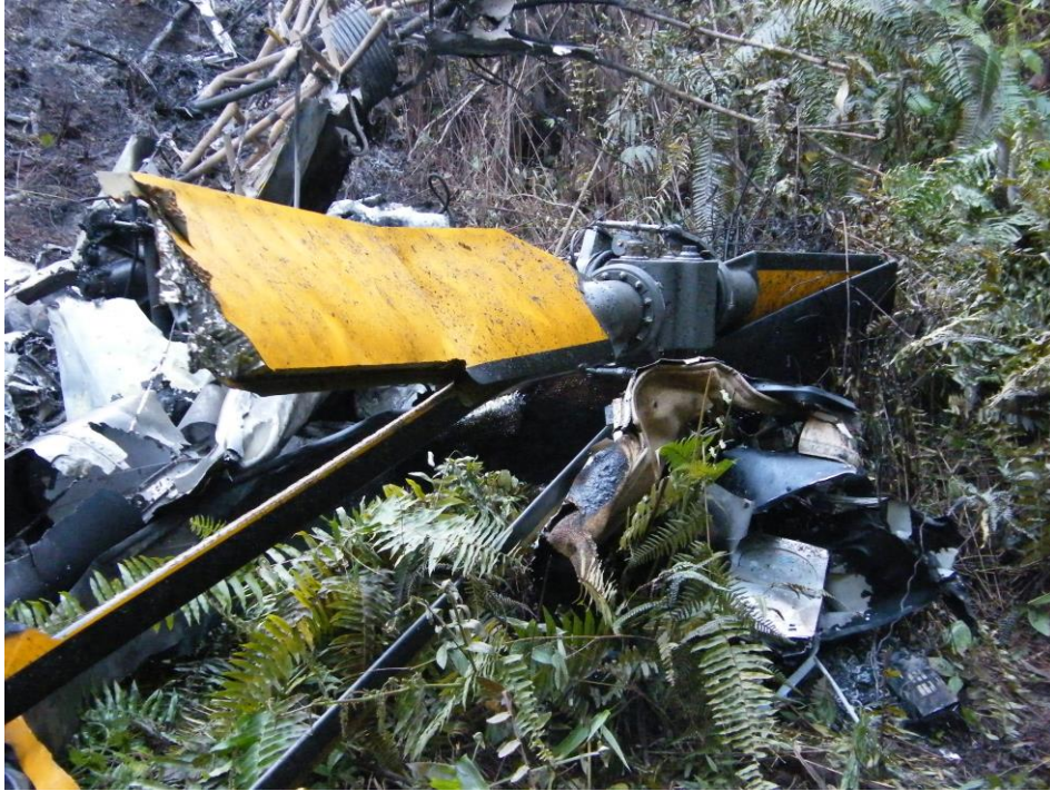
Imagen 05-A.- Aspas del rotor principal, nótese el grado de destrucción, evidencia de impacto con potencia.
