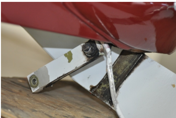
Illustratie 2: losgekomen borgingsplaatje rechterhoofdlandingsgestel (bron: KLPD)
