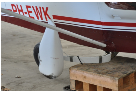
Illustratie 1: omgeklapte rechterhoofdlandingsgestel (bron: KLPD)
