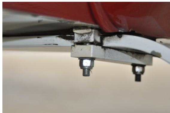
Illustratie 3: borgingsplaatje linkerhoofdlandingsgestel (bron: KLPD)
