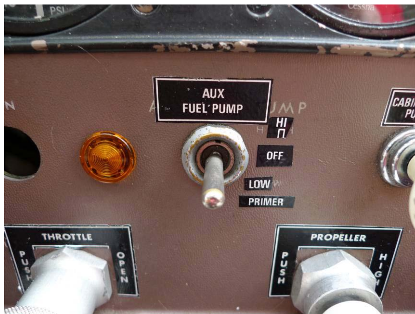
Fig. 8 Positioner för strömbrytare till bränslepump, High and Low.
