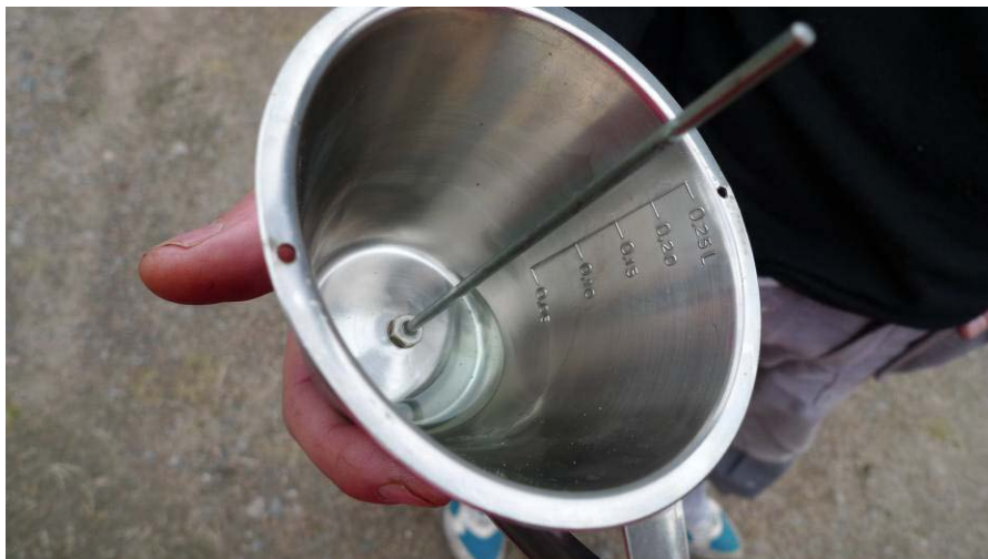
Fig. 5 Uppmätt bränsle i höger tank, notera att översta skalsträcket är 2,5 dl.
