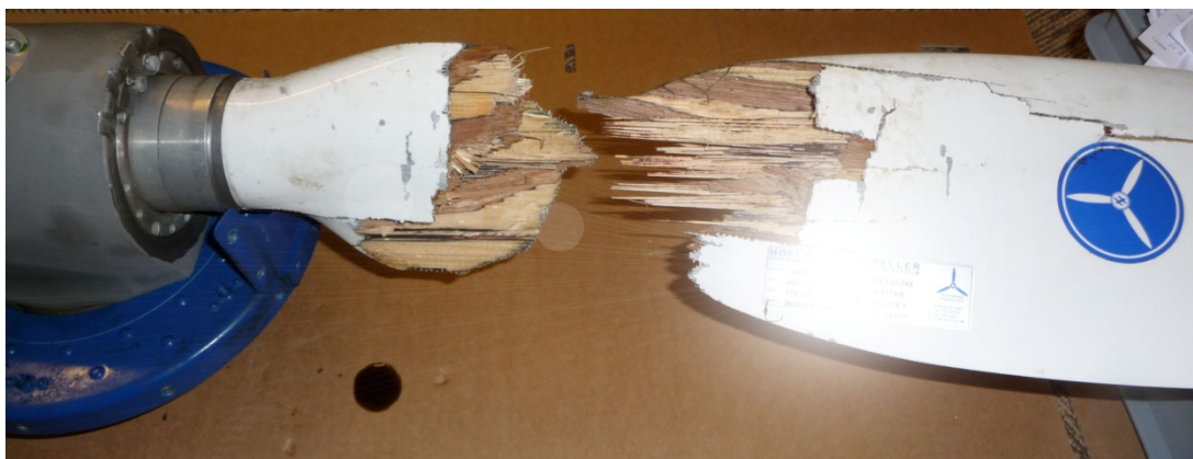
Afbeelding 2: de breuk van het propellerblad
