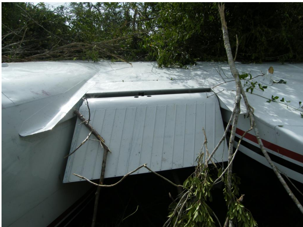
Imagen 04a.- Vista posterior de la sección del ala derecha y el flap de la misma.
