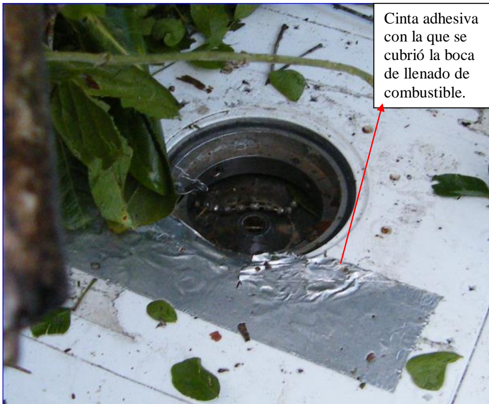
Imagen 05a.- Vista de la boca de llenado del tanque de combustible. Notese que la ausencia del tapón de combustible y los restos de cinta adhesiva del tipo “Duct tape” que se colocó en su lugar.
