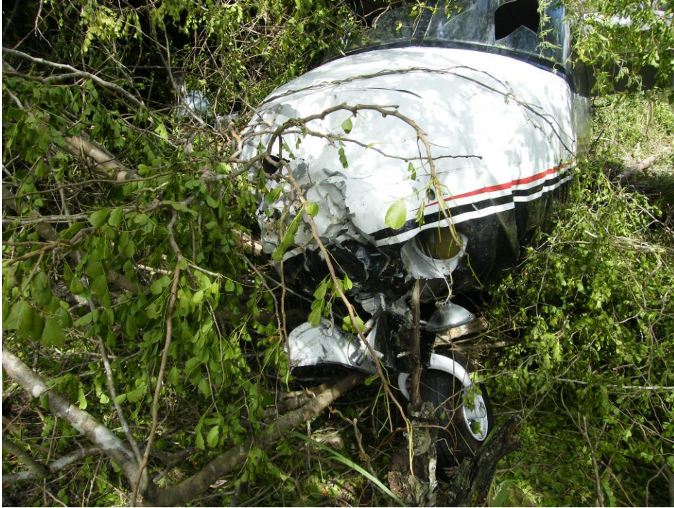
Imagen 01.- Vista frontal de la aeronave, en donde podemos apreciar los daños sufridos en la parte delantera y el tren delantero.
