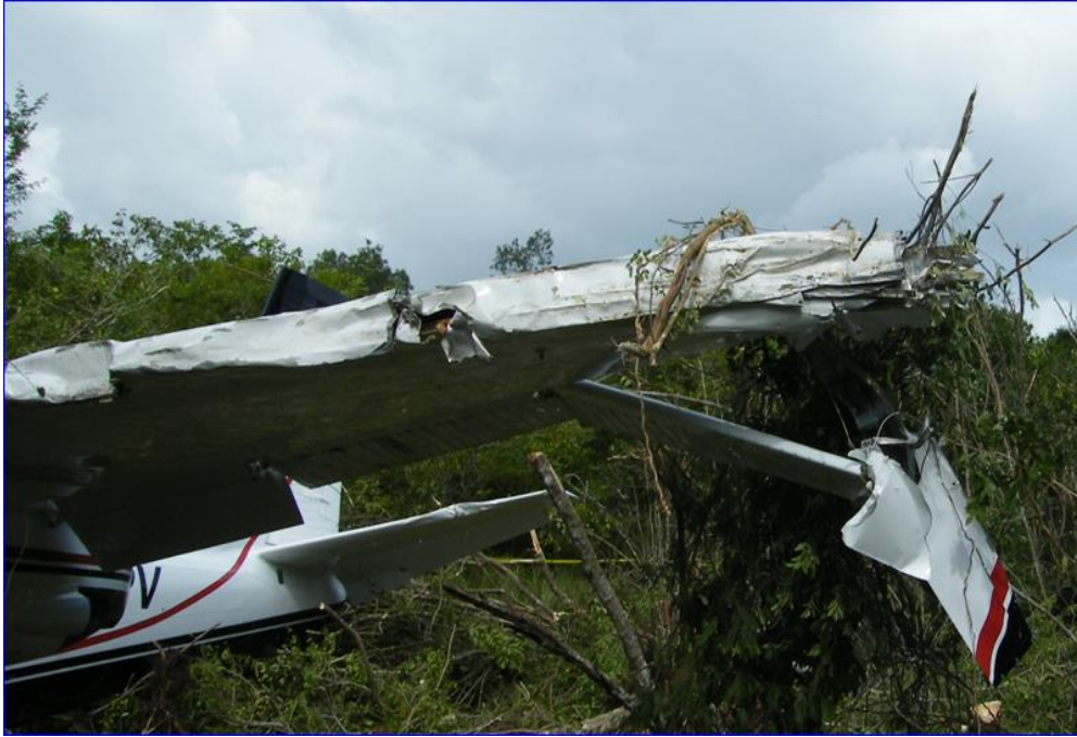
Imagen 03.- Vista del ala izquierda de la aeronave. En ella podemos apreciar los daños causados por los arboles del lugar en donde aterrizó de emergencia.
