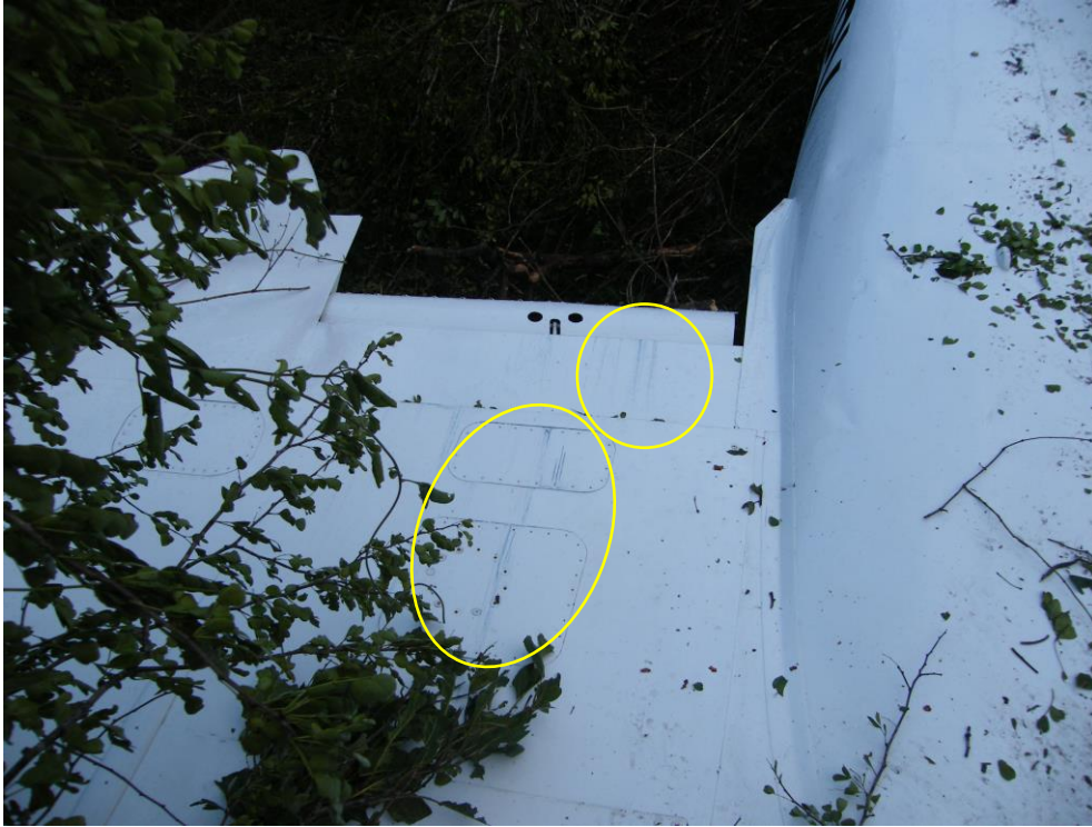
Imagen 06a.- Vista de la parte superior del ala derecha en su unión con el fuselaje. Dentro de los círculos se puede apreciar las marcas de combustible que escapó por la boca de llenado.
