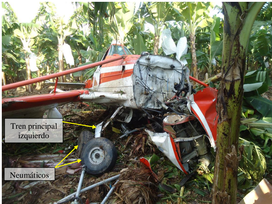
Imagen 04.- Vista frontal de la aeronave. Nótese los neumáticos en la imagen. El neumático situado al frente pertenece al tren principal izquierdo, el cual se desprendió debido al derrape de la aeronave sobre su costado izquierdo.
