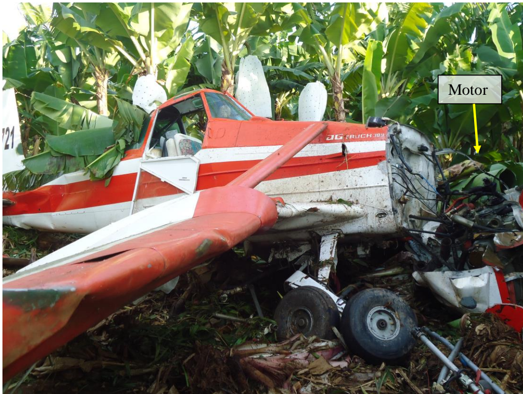
Imagen 03.- Vista del costado derecho de la aeronave, nótese el grado de los daños sufridos por ésta debido al impacto y al derrape contra el terreno.
