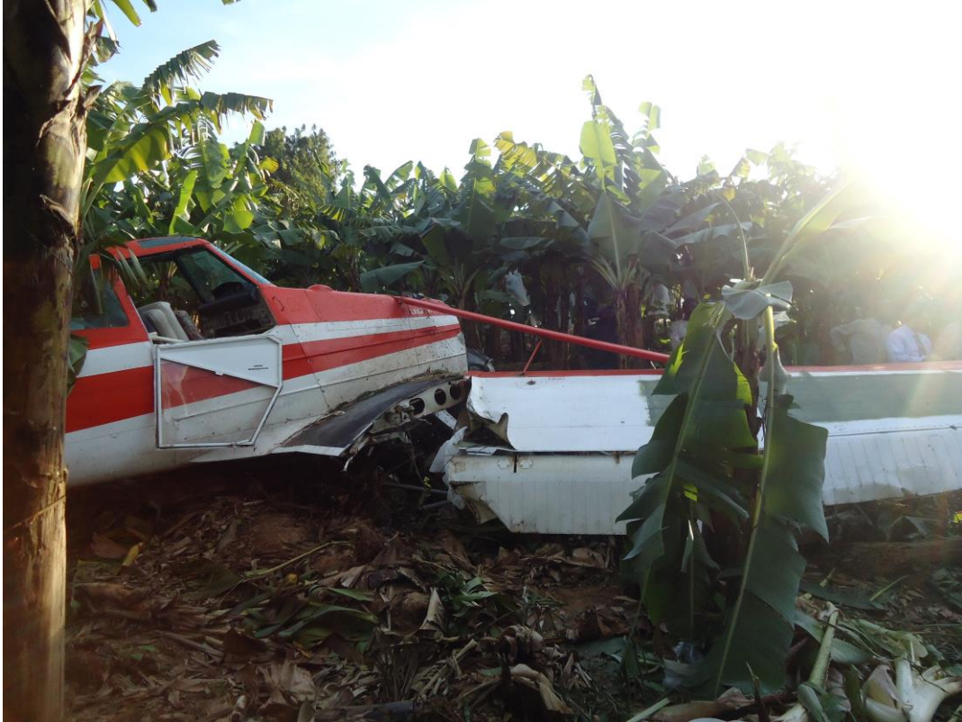
Imagen 05.- Vista del costado izquierdo de la aeronave, en la cual podemos apreciar el desprendimiento sufrido por el ala derecha, muestra de la magnitud del impacto de esta contra el terreno.
