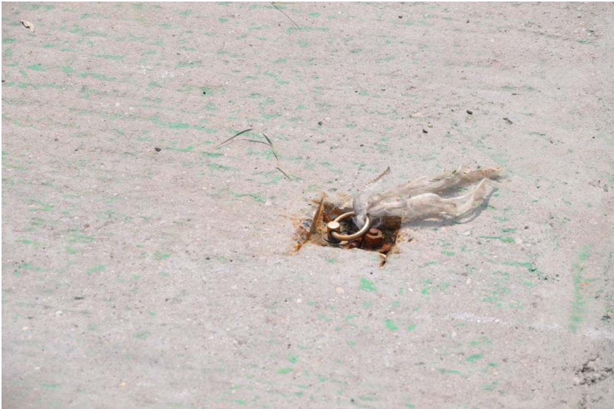
Foto 3: particolare cima di sinistra con segni di superamento del carico di rottura.
