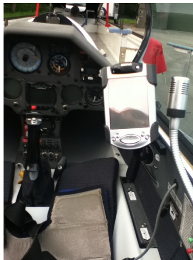
Afbeelding 3: hendel niet zichtbaar door positie van PDA
