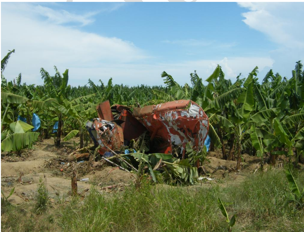
Imagen 04.- Aeronave accidentada. Nótese el grado de destrucción sufrida por esta luego de impactar el cable de guarda y posteriormente el terreno.
