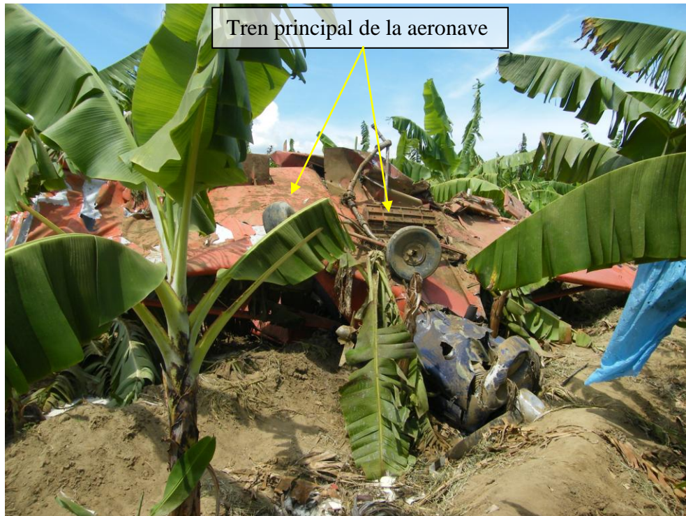
Imagen 05.- En esta imagen podemos apreciar la parte anterior de la aeronave y la posición invertida en la que terminó luego del impacto con el terreno y los vuelcos que esta realizó enredada con el cable.
