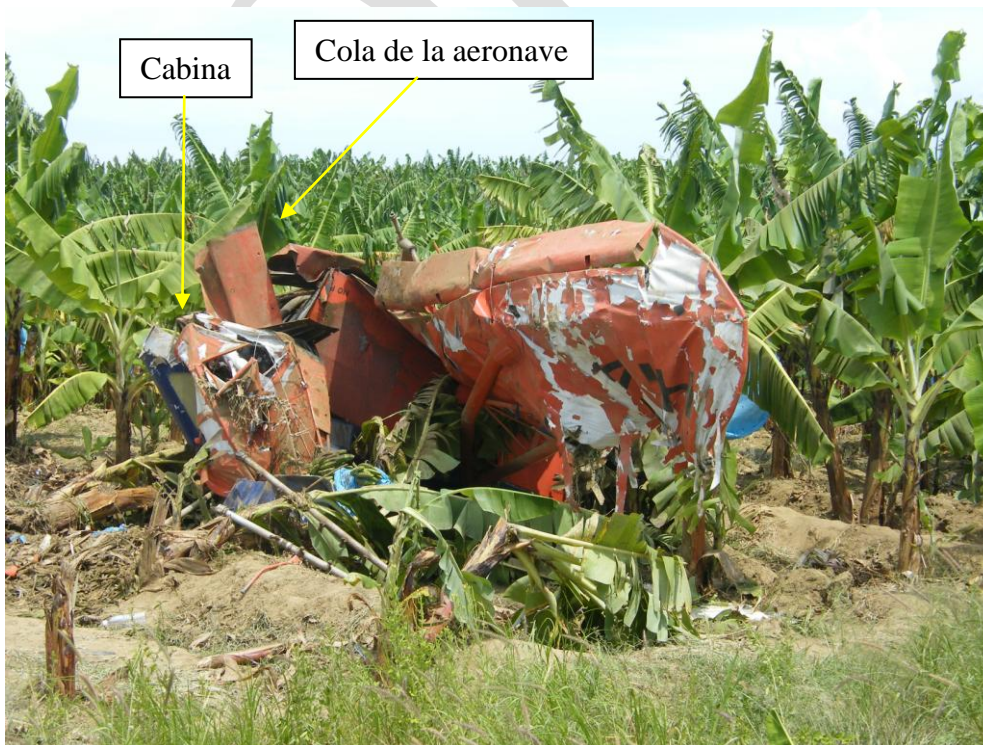
Imagen 06.- Vista de los restos de la aeronave. En la imagen podemos observar que la parte posterior de la aeronave quedó totalmente comprimida con el fuselaje.
