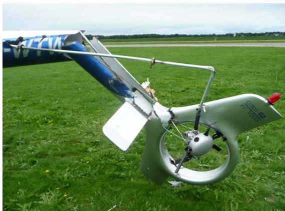
Figuur 3: beschadigde staart en staartrotor aandrijf-as
