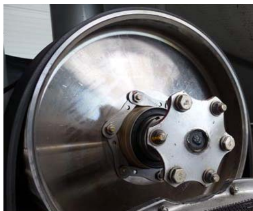
Figuur 6: motoraangedreven poelie met verbogen koppeling
