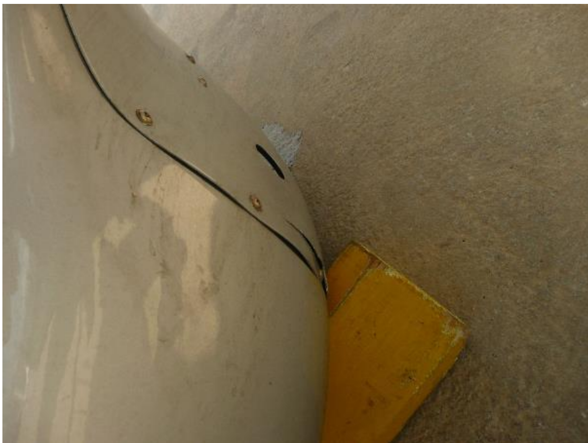
Slika 14. Obloga kotača lijevog glavnog stajnog trapa
