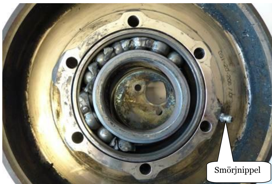
Figur 6 - Remskivan monterad på motorn, observera att kullagrets inre lagerbana är elliptisk. Lagrets tio kulor har komprimerats i en del av lagret. Kulhållaren har skadats och möjliggjort att kulorna kan flyttas så att avståndet mellan kulorna inte är jämt fördelat.
