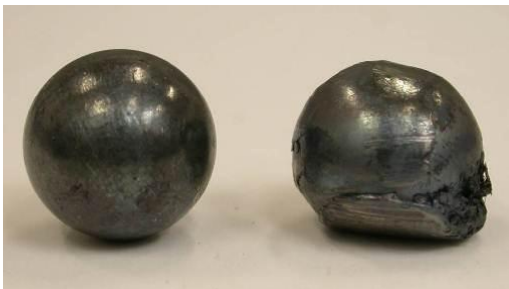
Figur 7 – Referenskula och kula med glidskador (Foto Exova)
