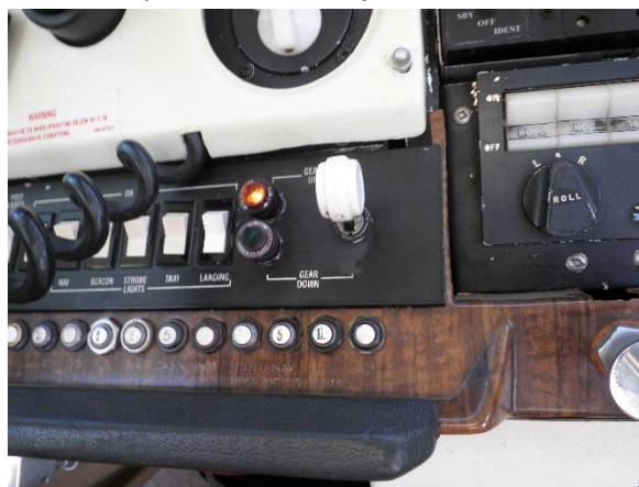
b) Narančasto svjetlo, vizualni pokazivač tranzicije stajnog trapa u gornji položaj
