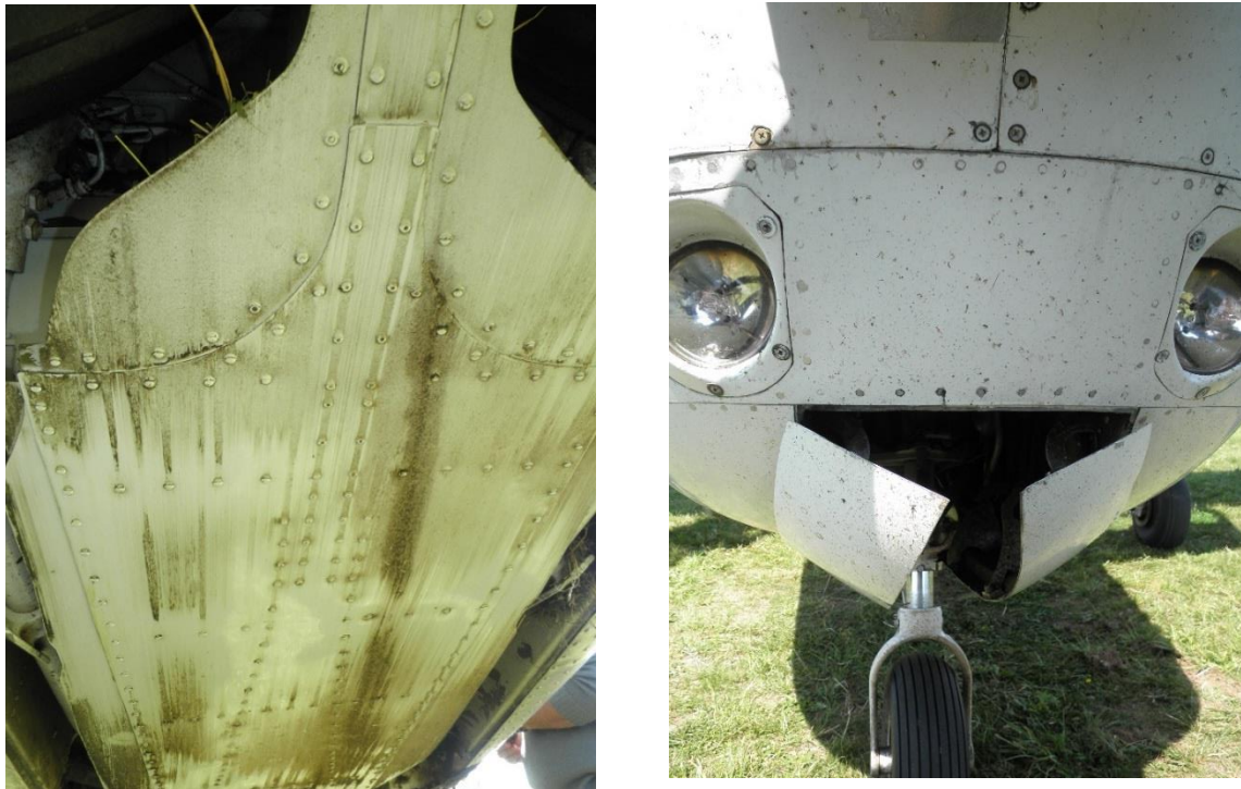
Slika 2. Oštećenja donjeg dijela trupa i vrata nosne noge
