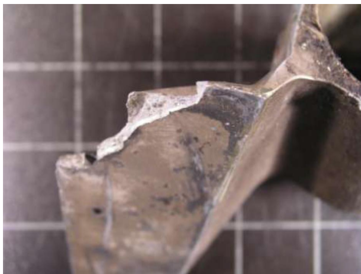
Slika 12. Dio 1 s prijelomnom površinom
