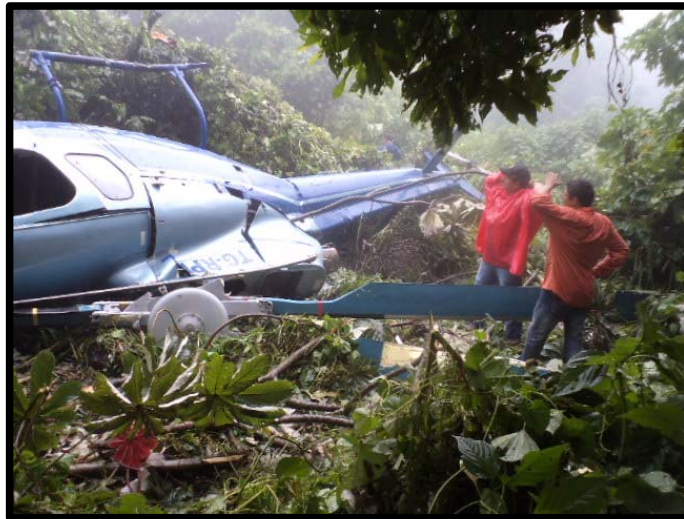
Fotografía No.: 03 Vista de los daños al Rotor Principal.
