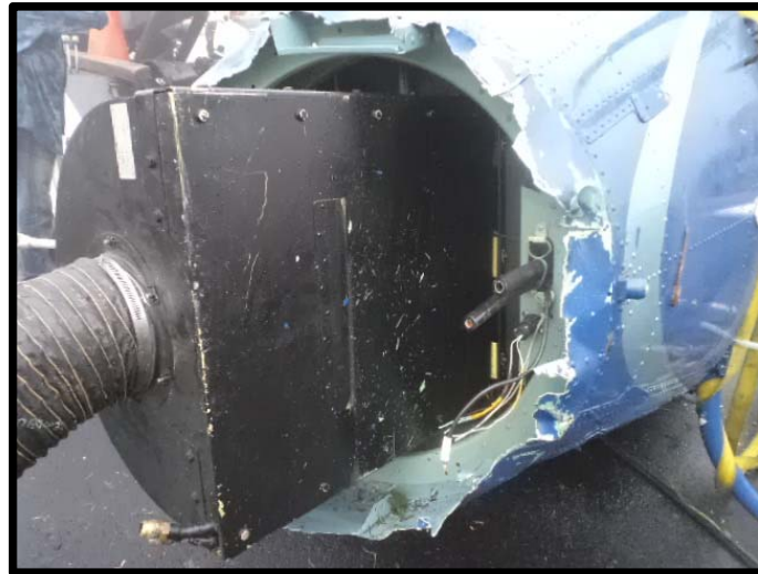
Fotografía No.: 11 Vista trasera del helicóptero sin el Botalón.
