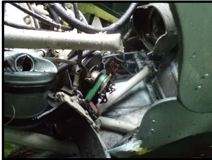
Fotografía No.: 07 Vista de los daños ocasionados a los soportes de la Transmisión.
