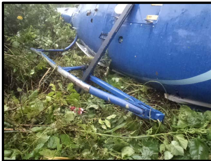
Fotografía No.: 08 Vista cercana del daño en el tren de aterrizaje.
