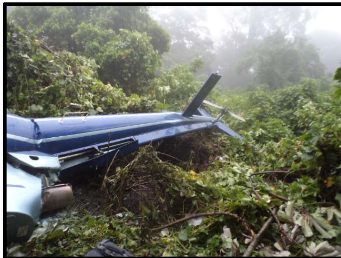
Fotografía No.: 04 Daño al Botalón de Cola.
