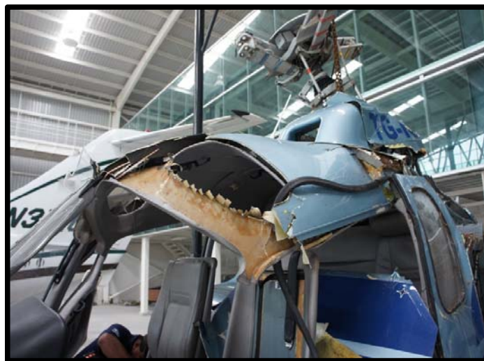
Fotografía No.: 14 Daño por deformación a la estructura.
