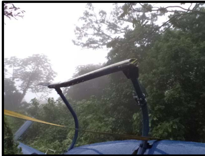
Fotografía No.: 09 Vista del daño en el tren de aterrizaje lado derecho.
