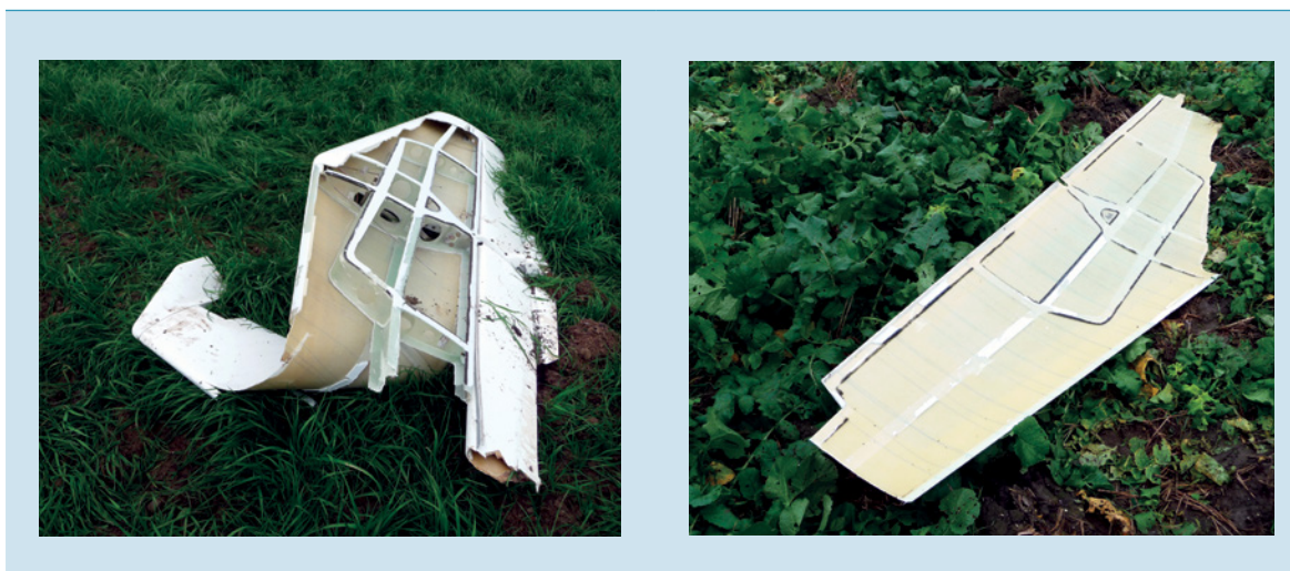
Figuur 11: Stabilo met hoogteroer (links) en de bovenhuid stabilo (rechts). (Bron: Onderzoeksraad voor Veiligheid)
