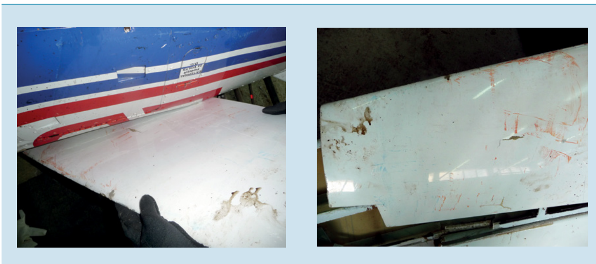
Figuur 9: Verfsporen van de registratie van de F22-B op het stabilo van de DA-40D. (Bron: Onderzoeksraad voor Veiligheid)
