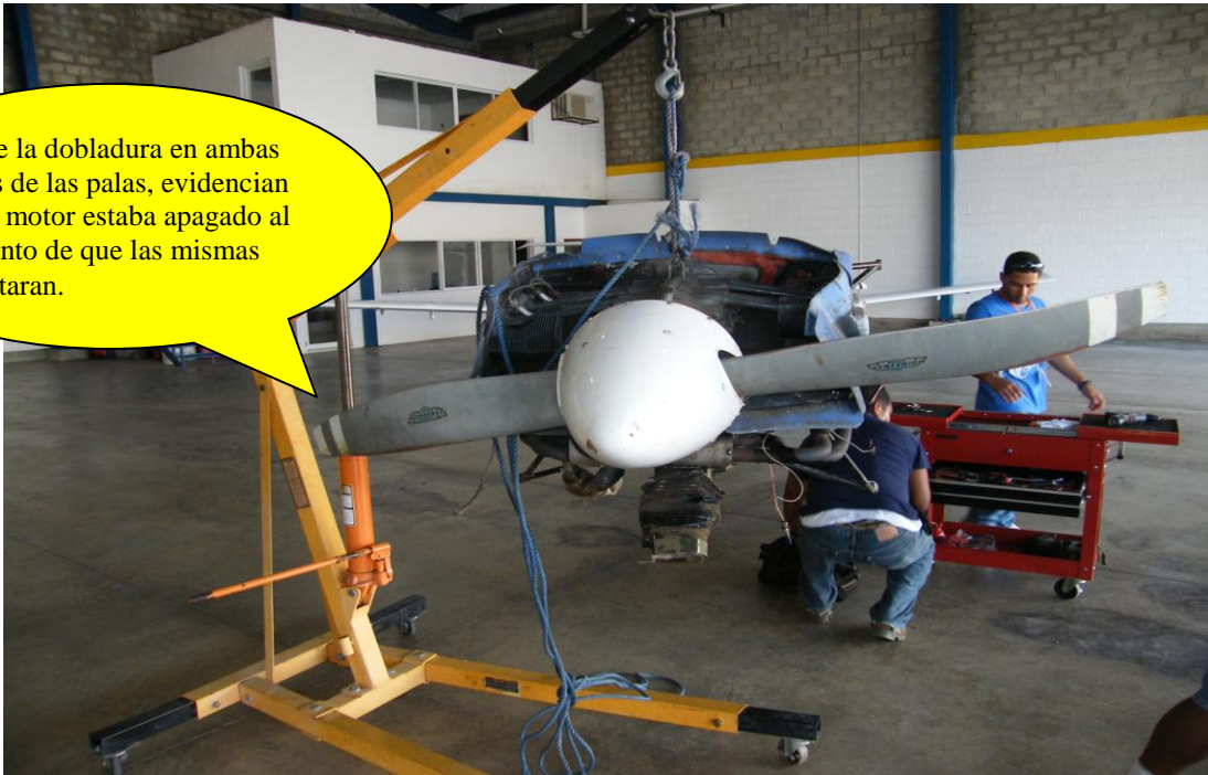
Motor de la aeronave desmontado para realizarle las pruebas pertinentes.
