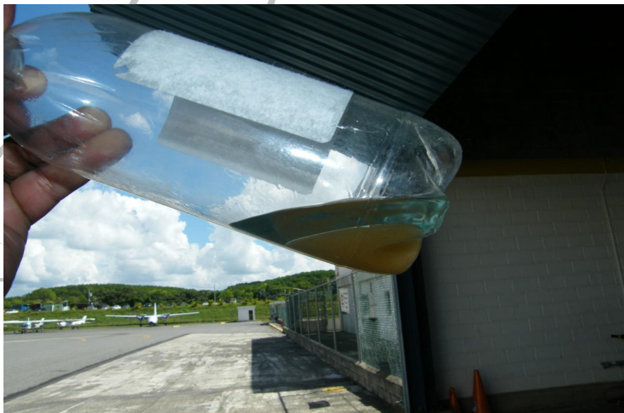
Nótese la cantidad de combustible (color azul parte superior del envase), y la presencia de agua turbia en la parte inferior del envase.
