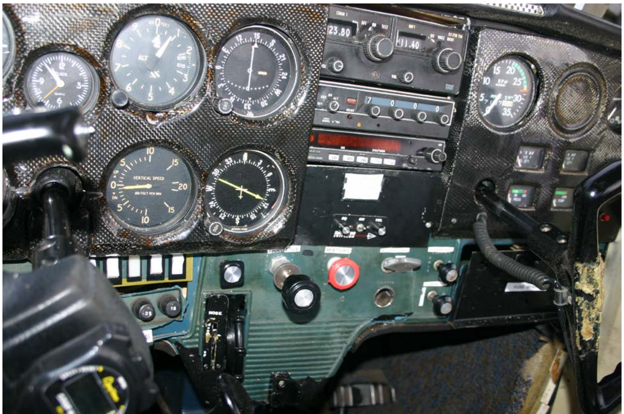
Foto 9: pannello strumenti. In primo piano, in basso, al centro: comando aria calda al carburatore, manetta del gas, comando (rosso) del correttore di miscela.
