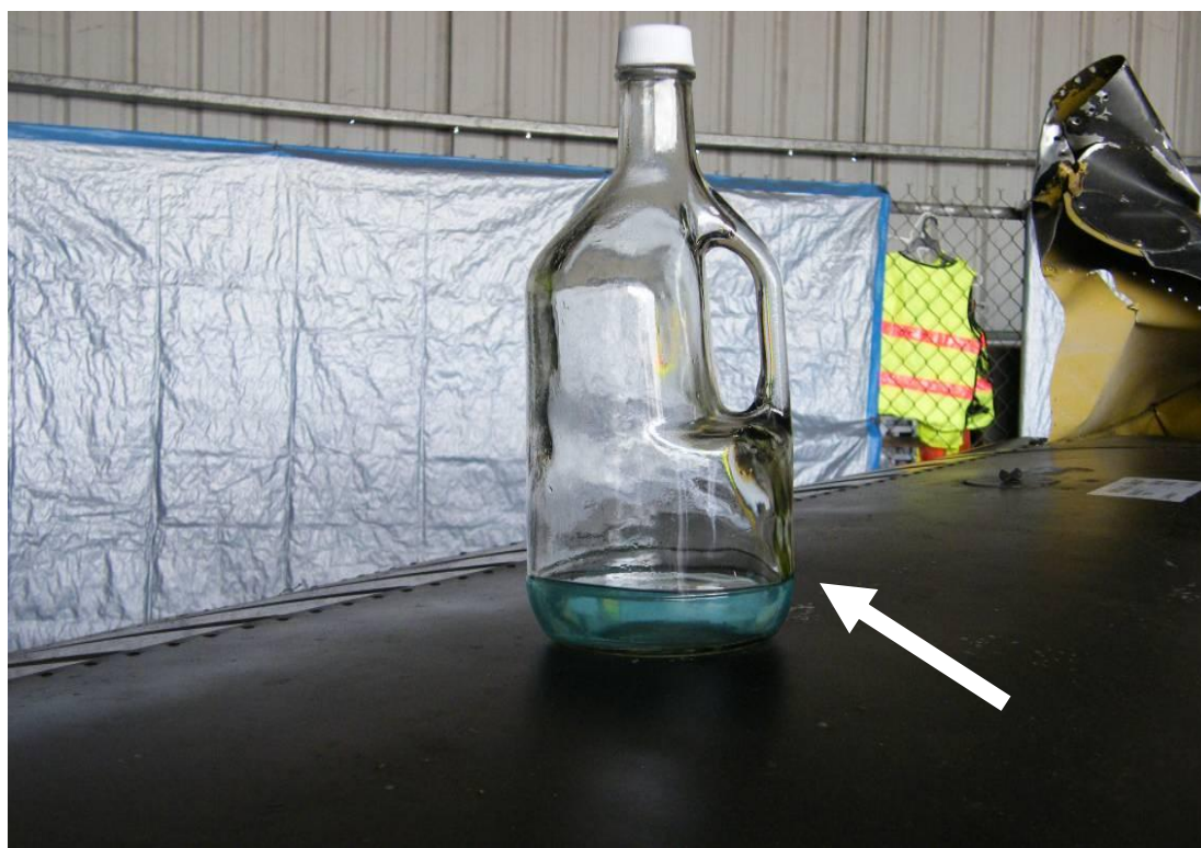
Nótese la cantidad total de carburante drenado de los tanques de combustible de la aeronave.
