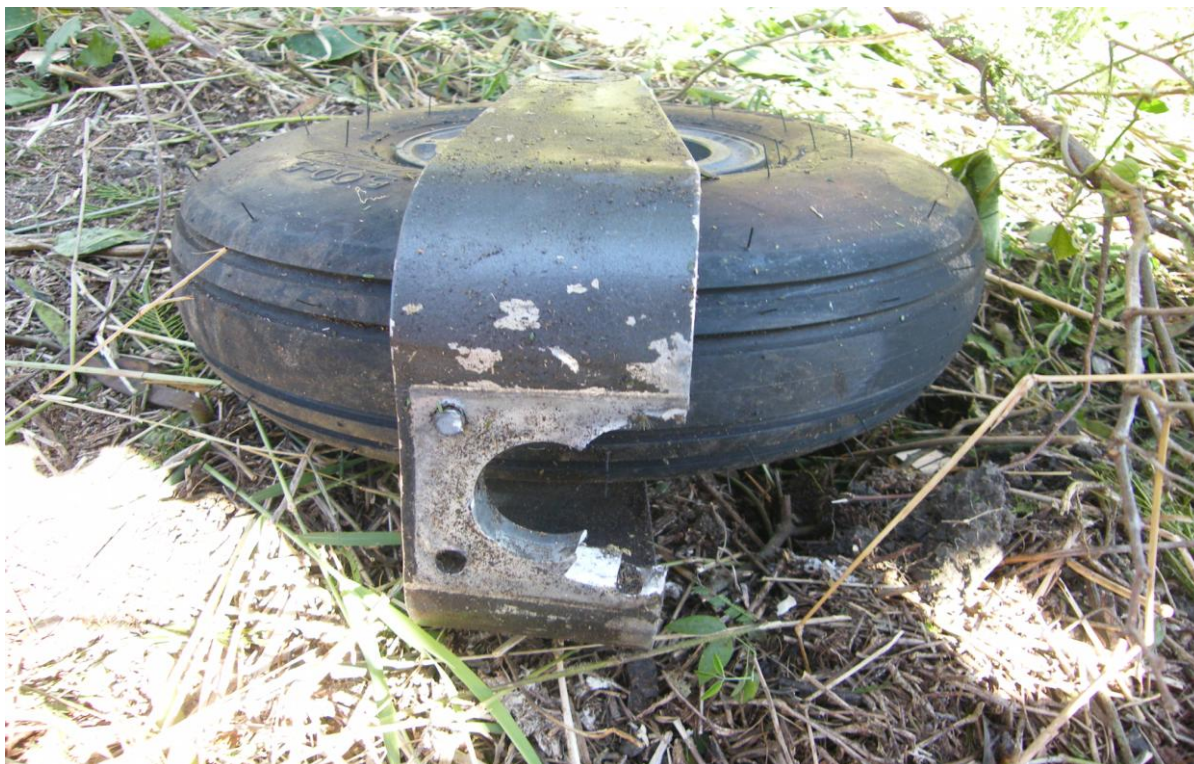
Rueda del tren de nariz desprendida del tren de aterrizaje después del impacto.
