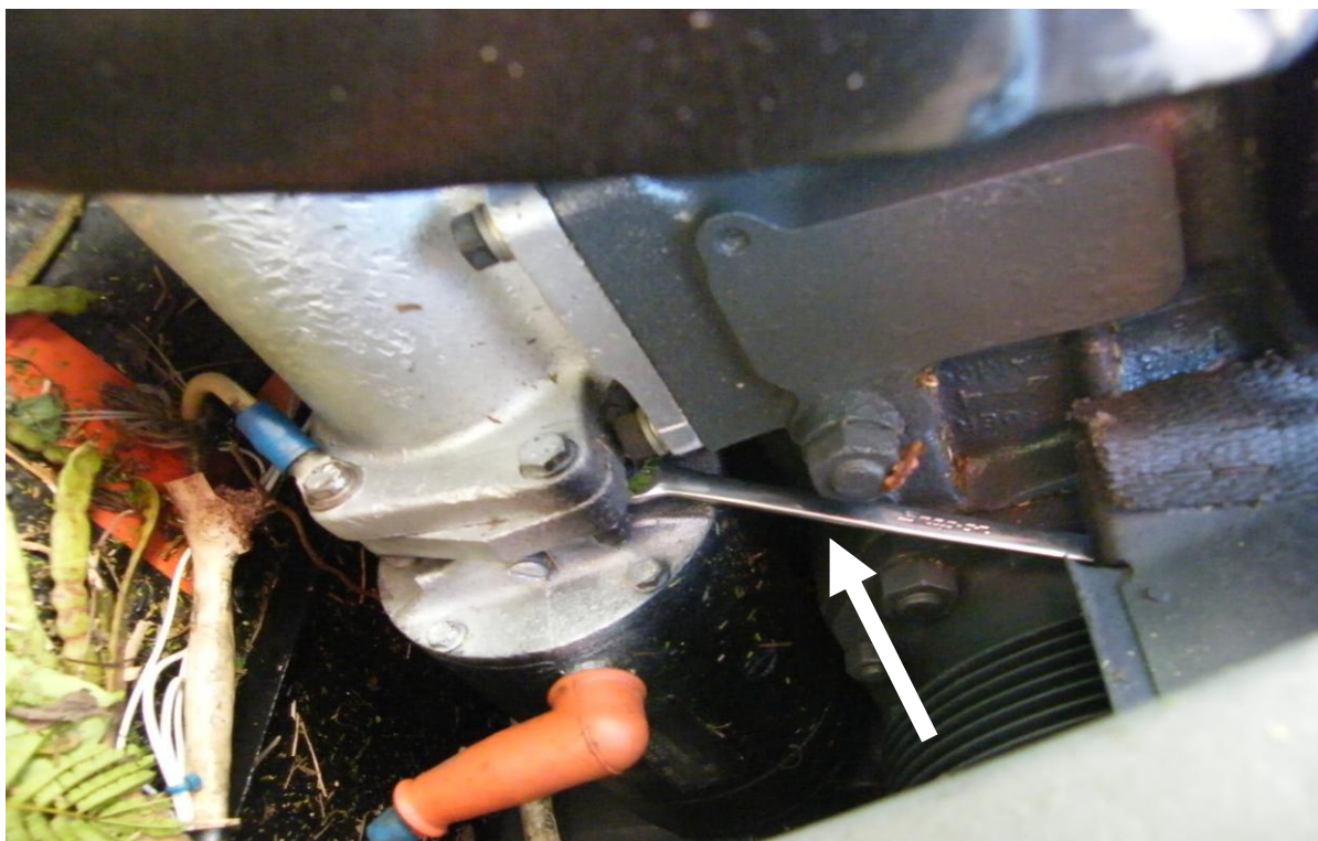
Herramienta encontrada entre el gobernador de la hélice y el motor de arranque de la aeronave, mientras se realizaba la inspección visual en el área del accidente.
