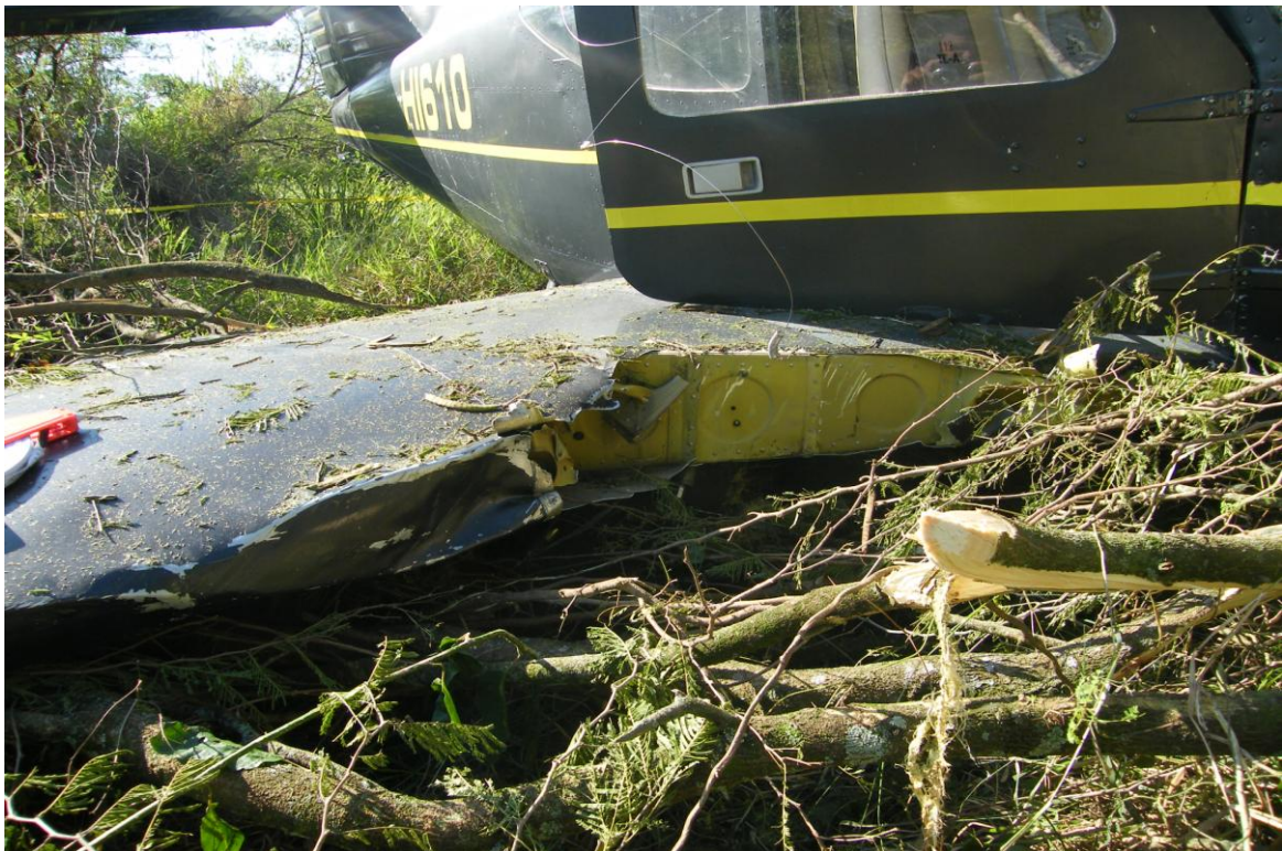
Nótese los daños recibidos por el ala derecha, producto del impacto con el árbol.
