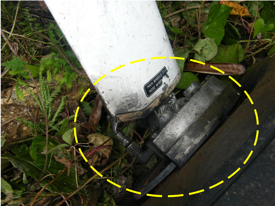
Conexión de la tubería del fluido hidráulico de los frenos lado izquierdo, nótese que no hay ninguna fuga de líquido de frenos.
