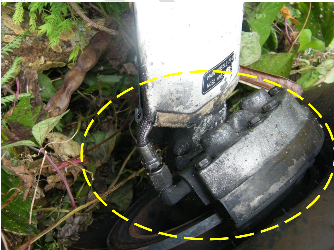
Otra vista del sistema de frenos del lado izquierdo, sin ninguna fuga.
