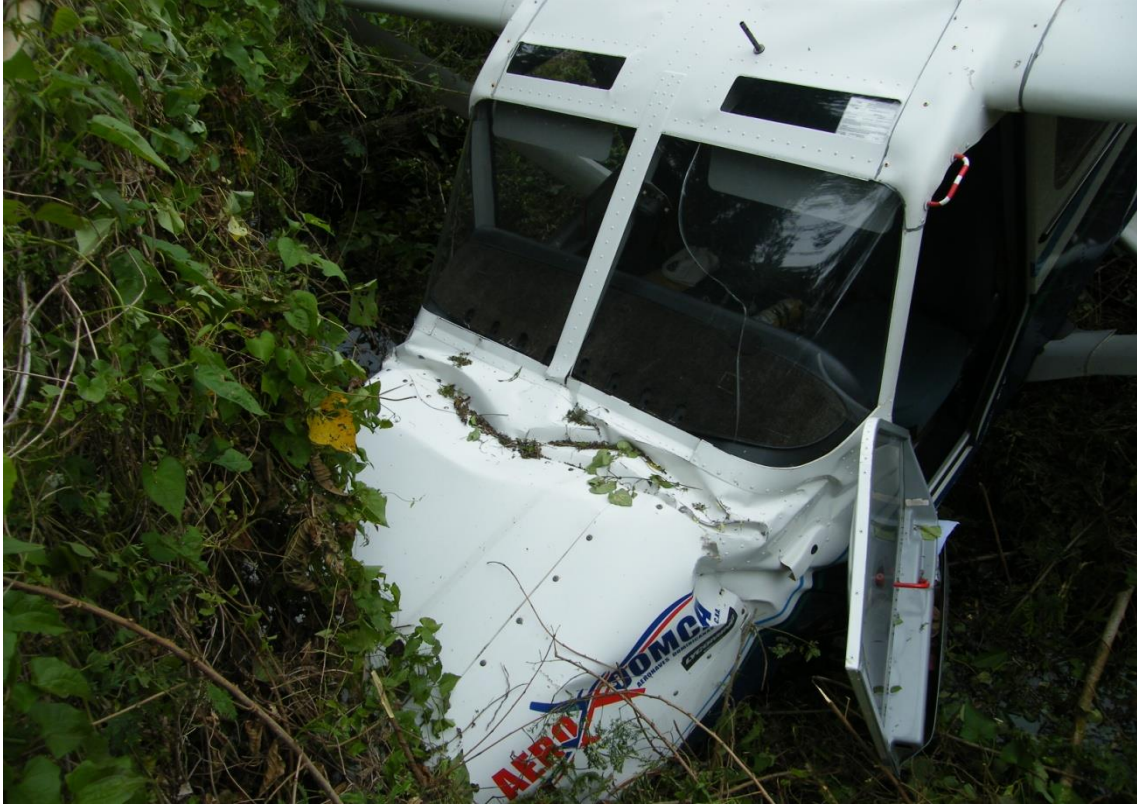
Nótese la deformación del fuselaje en el área del motor.
