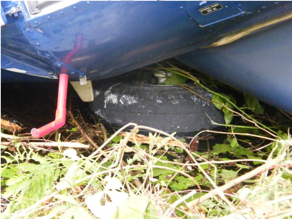
Rueda del tren de aterrizaje de nariz roto, quedó debajo del fuselaje.
