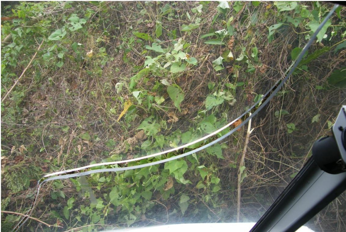
Rotura del parabrisas izquierdo.
